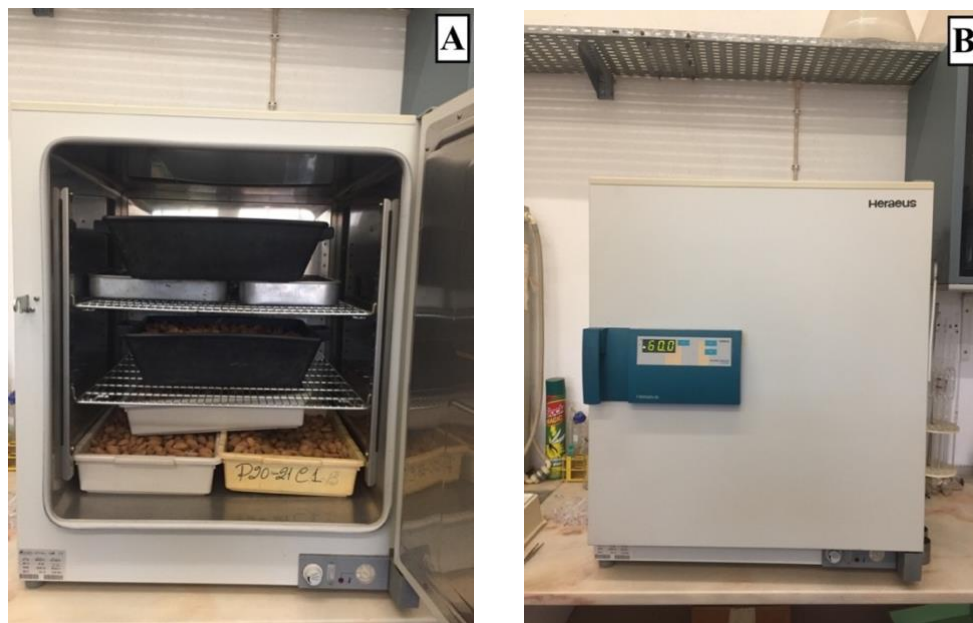
Figura 48- A- Colocação das amostras na estufa ventilada; B- Programação da temperatura da estufa a 60°C
