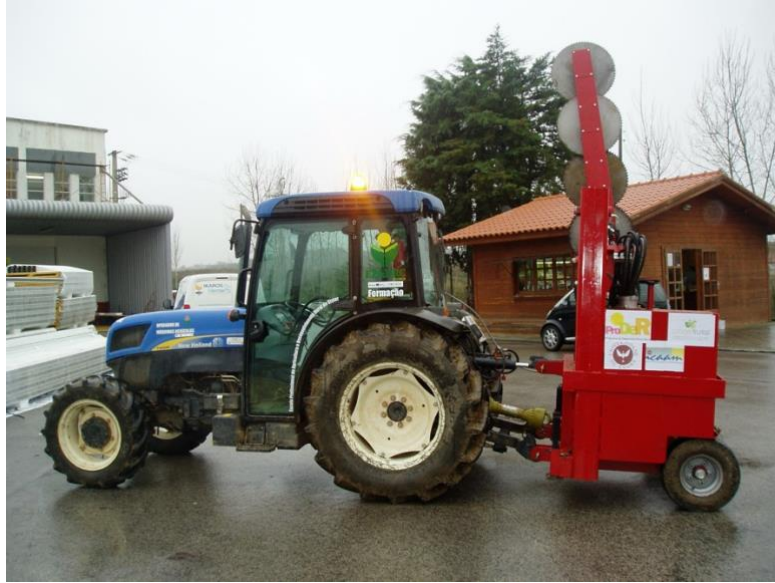
Figura 23- Máquina de podar de discos montada no sistema de engate de três pontos do trator (Fonte: A.Dias)
