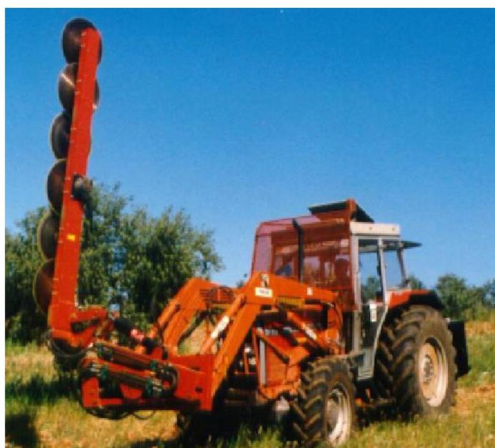
Figura 30- Máquina de podar de discos R&O, montada no carregador frontal de um trator (Fonte: A. Dias)
