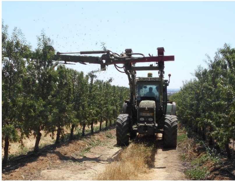
Figura 35- Corte horizontal na parte superior da copa
