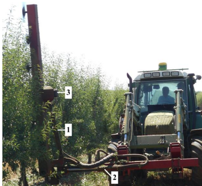
Legenda: 1- Cilindro hidráulico (1); 2- Cilindro hidráulico (2); 3- Motor hidráulico.
