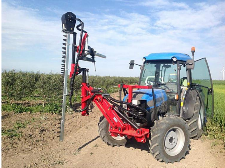
Figura 21- Máquina de podar de facas montada nos contrapesos frontais do trator (Fonte: www.id-david.com )
