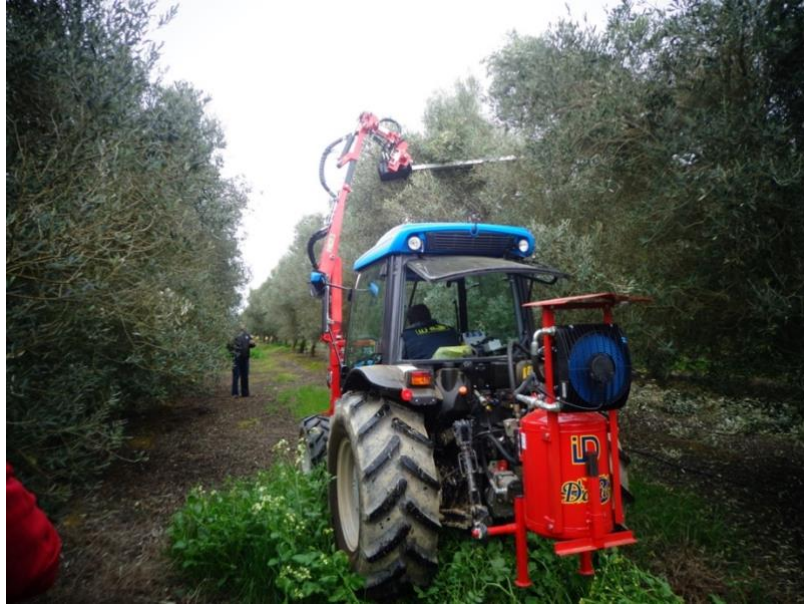
Figura 25- Depósito de óleo montado nos três pontos do trator (Fonte: www.id-david.com )
