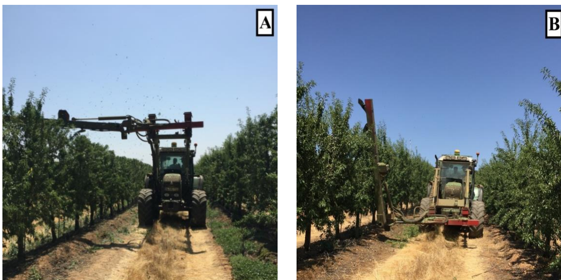
Figura 19- A- Máquina de podar a efetuar corte horizontal na parte superior da copa (“ Topping ”); B- Máquina de podar a efetuar corte vertical na face lateral da copa (“ Hedging ”).
