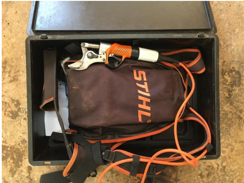
Figura 37- Tesoura de poda a bateria STIHL ASA 85
