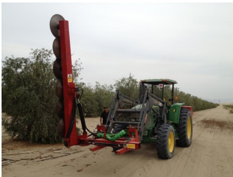
Figura 20- Máquina de podar de discos montada no carregador frontal do trator (Fonte:www.reynolds-pirra.com)
