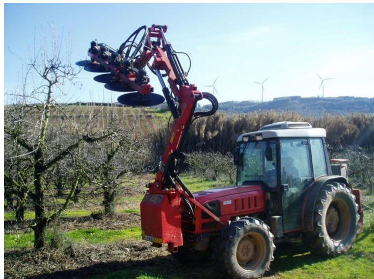
Figura 22- Máquina de podar de discos montada nos contrapesos frontais do trator (Fonte: A. Dias)
