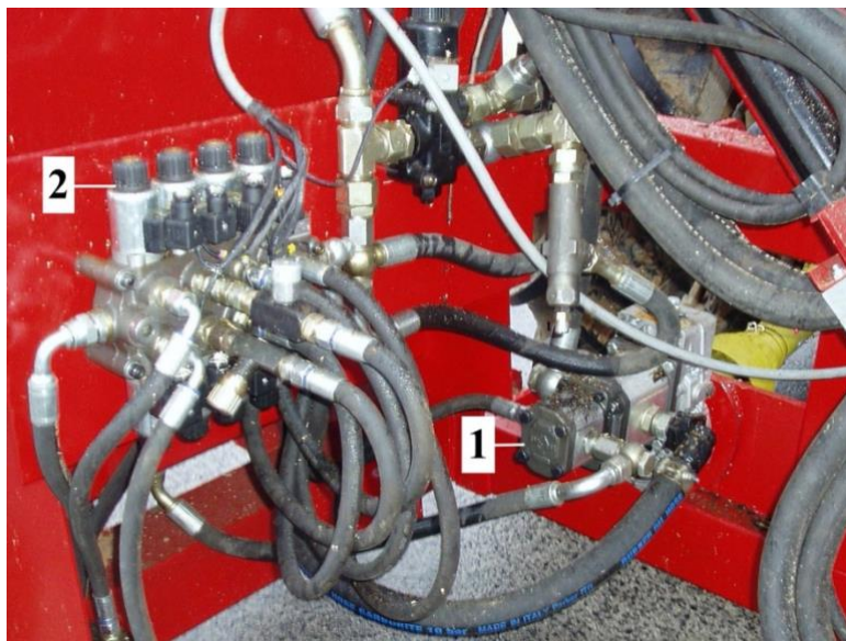
Figura 26- Componentes do sistema hidráulico de uma máquina de podar (Adaptado de A. Dias)
