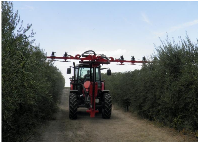
Figura 24- Máquina de podar de discos montada nos contrapesos frontais, com duas barras de corte de discos (Fonte: www.id-david.com )
