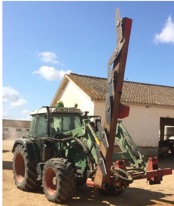
Figura 33- Aspecto da máquina de podar com serras circulares na barra de corte
