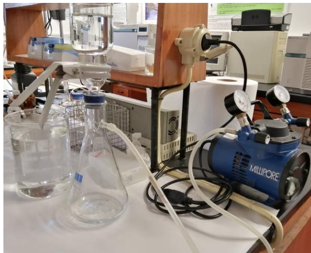
Figura 17. Fotografia da filtração do eluente A (fase móvel A) com a bomba de vácuo no lado direito (foto do autor).
