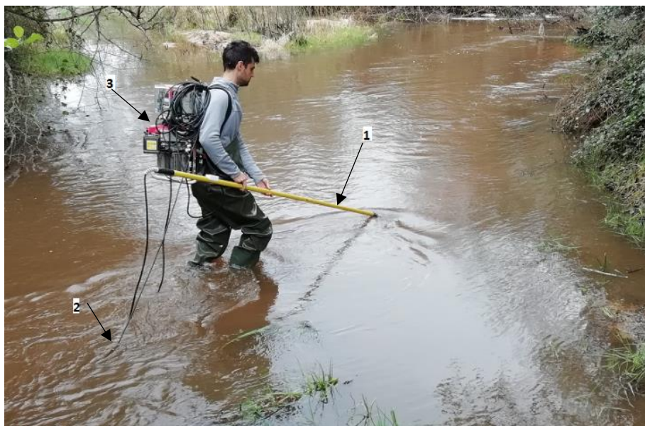
Fig. 4 Fotografia do método de captura através da pesca elétrica, onde podemos observar o (1) ânodo, o (2) cátodo e o (3) gerador dorsal.
