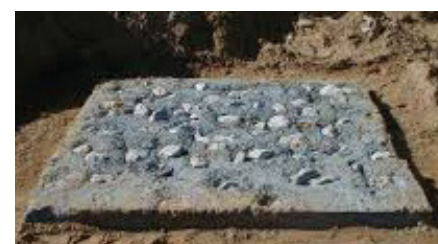
Fig. 155 a 159 – Materiais propostos: de baixo para cima: embasamento de betão ciclópico, tufo calcário, tijolo maciço, aço negro, tecido
