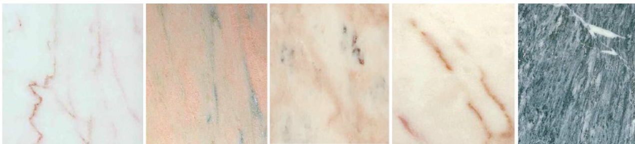
Fig. 6 – Os principais tipos de mármore do anticlinal Branco Corrente, Rosa do Rosal, Rosa Aurora (Vigária), Creme da Lagoa e Ruivina. Fonte: Catálogo da D.G.G.M, 1983
