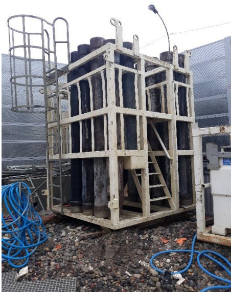
Figura 29 Suporte em ferro para arrumamento dos tubos que constituem a coluna de betão
