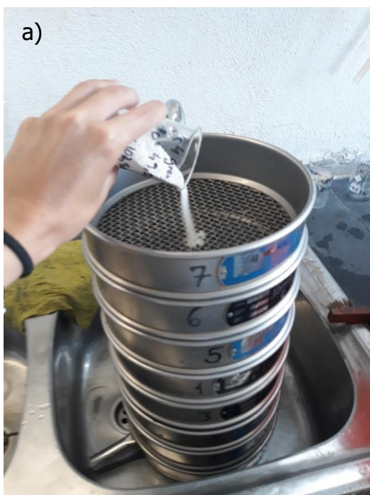
Figura 35 Realização do ensaio de granulometria por via húmida: a) Empilhamento dos crivos da maior malha (crivo 7) até ao crivo de menor malha (crivo 1) com o fundo e o escoador de sedimento; b) amostras depois de secas obtidas do ensaio.
