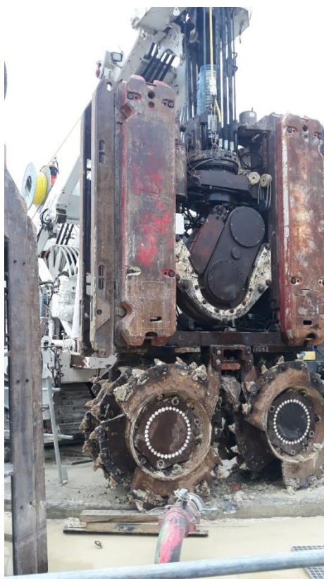
Figura 21 Sistema de escavação por fresa – MC96 da Bauer
