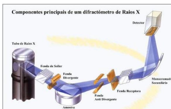
Figura 41 Esquema de um difractor de fonte linear. Fonte: Carvalho (2008).
