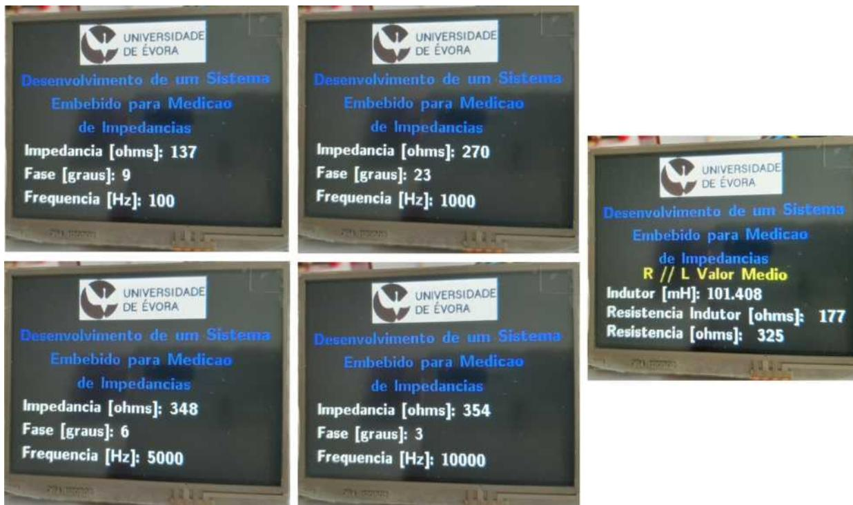
Figura 40: Apresentação no LCD dos resultados da medição de impedância e fase para a resistência de  $330 \Omega$  em paralelo com o indutor de 100 mH
