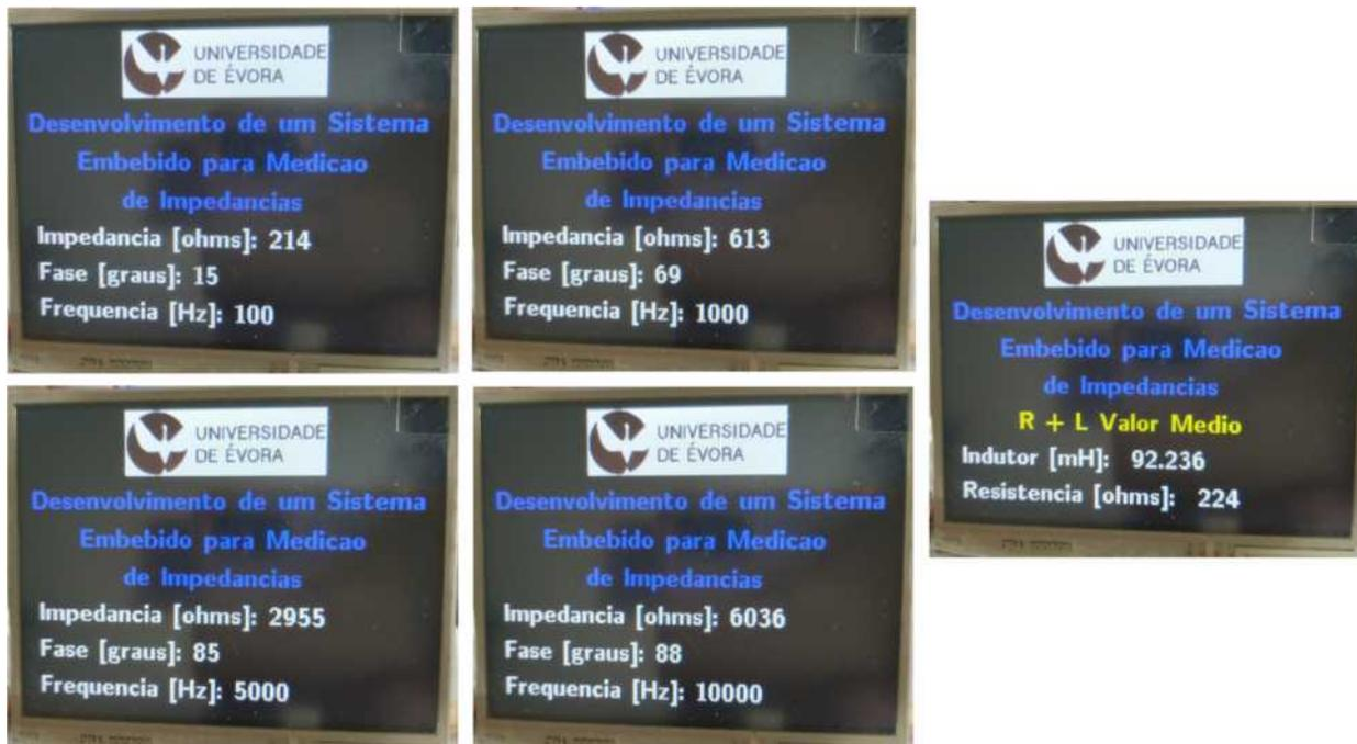
Figura 32: Apresentação no LCD dos resultados da medição de impedância e fase para o indutor de 100 mH
