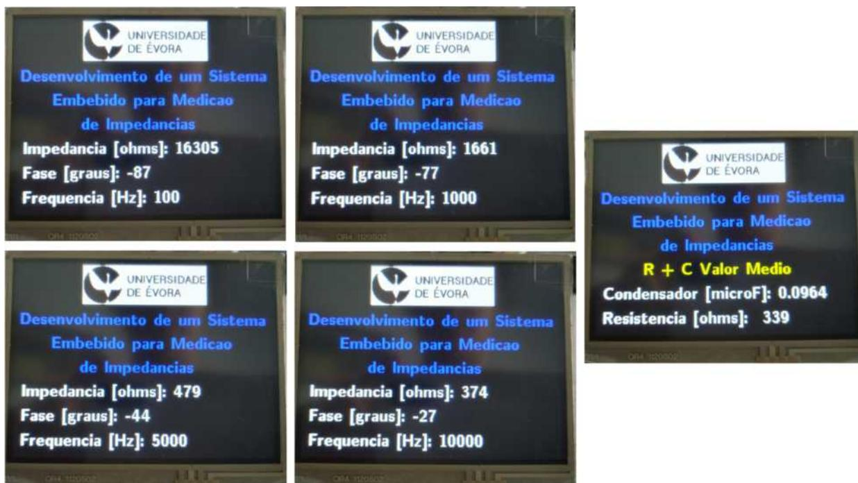
Figura 33: Apresentação no LCD dos resultados da medição de impedância e fase para a resistência de 330  $\Omega$  em série com o condensador de 0.1  $\mu\text{F}$
