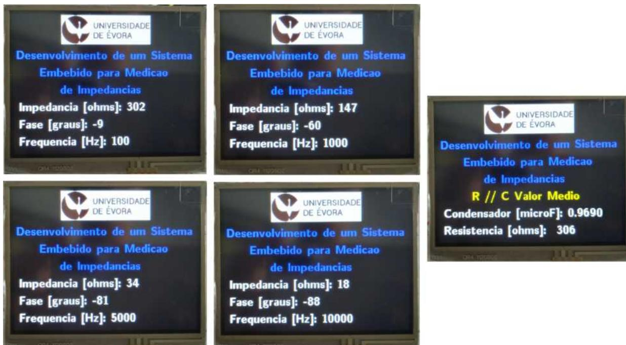
Figura 36: Apresentação no LCD dos resultados da medição de impedância e fase para a resistência de  $330 \Omega$  em paralelo com o condensador de  $1 \mu\text{F}$
