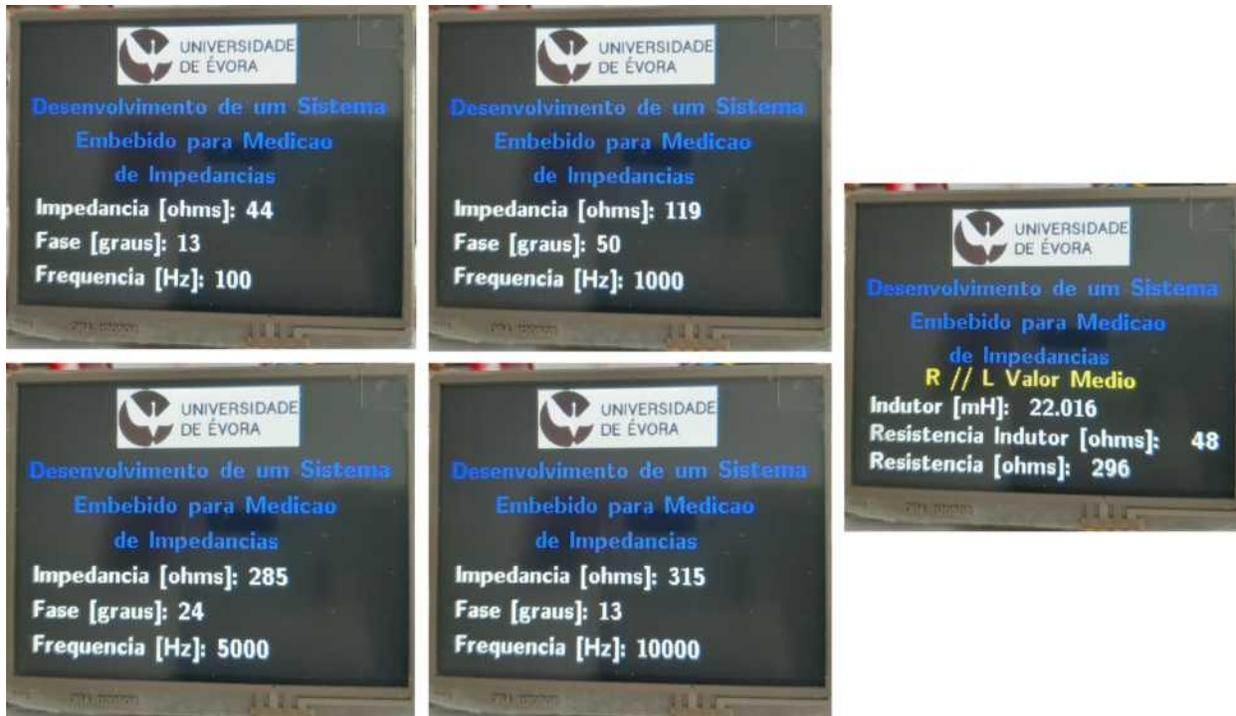
Figura 39: Apresentação no LCD dos resultados da medição de impedância e fase para a resistência de 330 Ω em paralelo com o indutor de 22 mH
