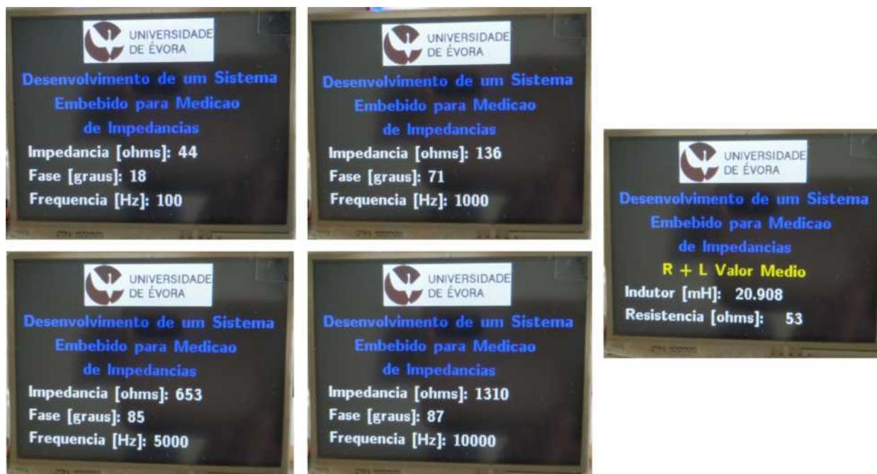
Figura 31: Apresentação no LCD dos resultados da medição de impedância e fase para o indutor de 22 mH
