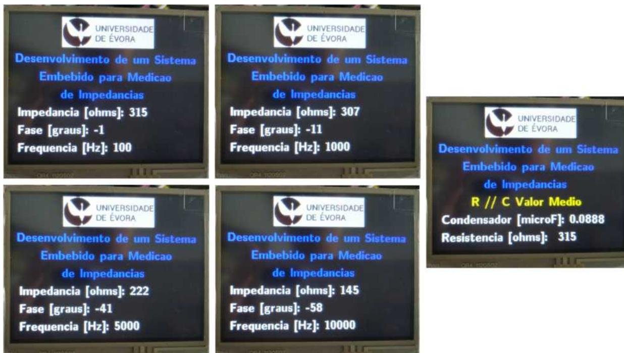
Figura 35: Apresentação no LCD dos resultados da medição de impedância e fase para a resistência de  $330 \Omega$  em paralelo com o condensador de  $0.1 \mu\text{F}$
