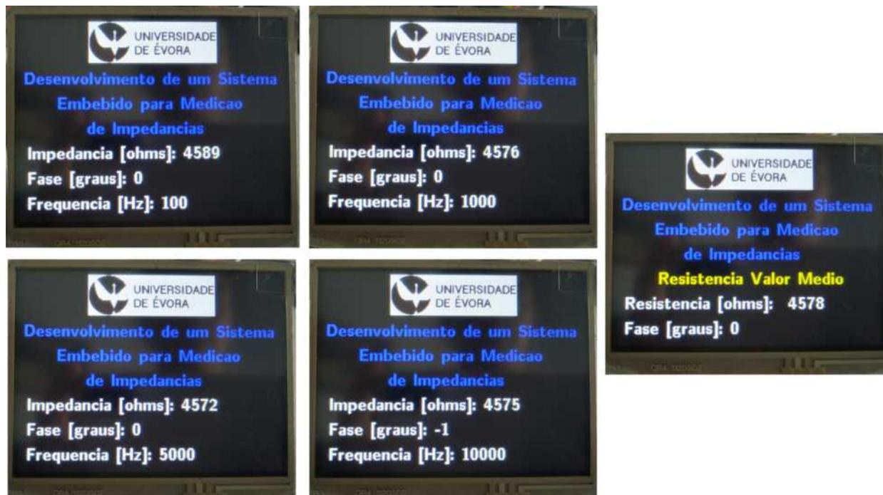
Figura 28: Apresentação no LCD dos resultados da medição de impedância e fase para a resistência de 4700 Ω
