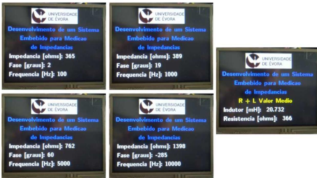
Figura 37: Apresentação no LCD dos resultados da medição de impedância e fase para a resistência de  $330 \Omega$  em série com o indutor de  $22 \text{ mH}$
