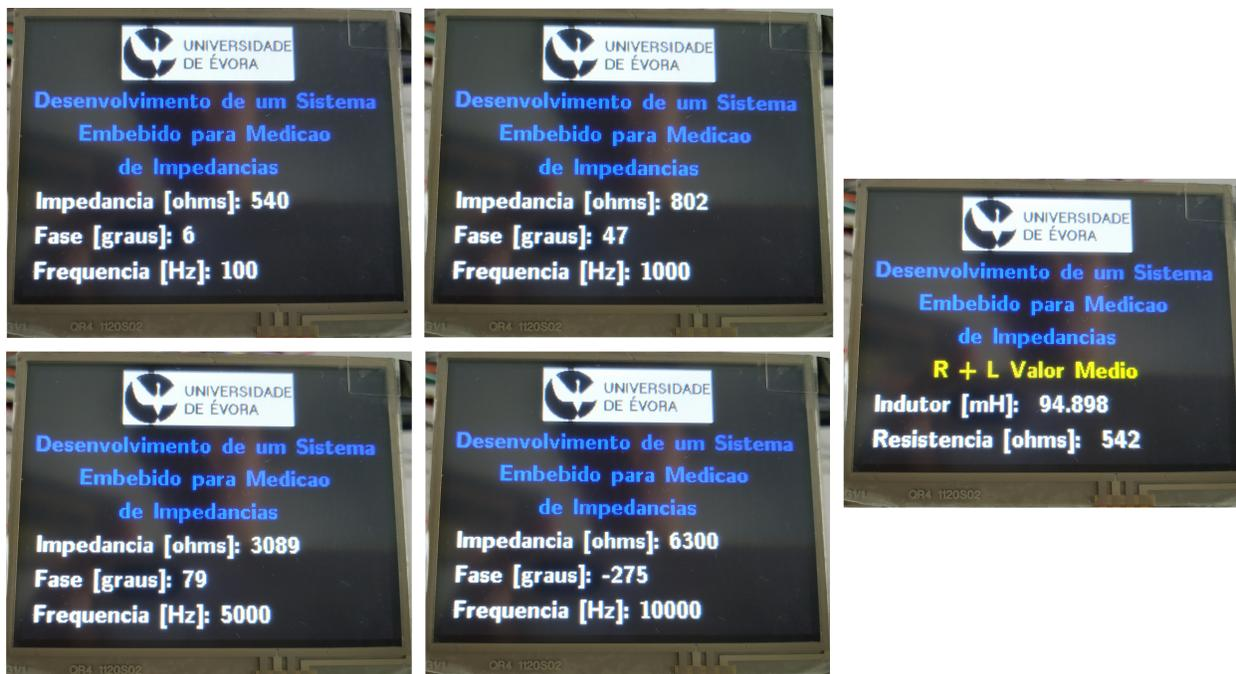
Figura 38: Apresentação no LCD dos resultados da medição de impedância e fase para a resistência de 330 Ω em série com o indutor de 100 mH
