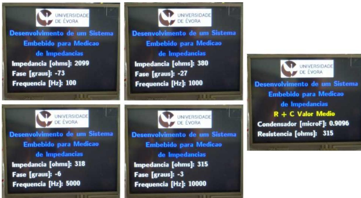
Figura 34: Apresentação no LCD dos resultados da medição de impedância e fase para a resistência de  $330 \Omega$  em série com o condensador de  $1 \mu\text{F}$
