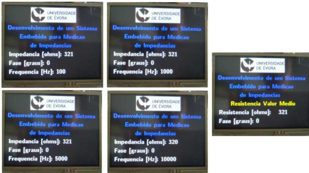
Figura 27: Apresentação no LCD dos resultados da medição de impedância e fase para a resistência de 330  $\Omega$
