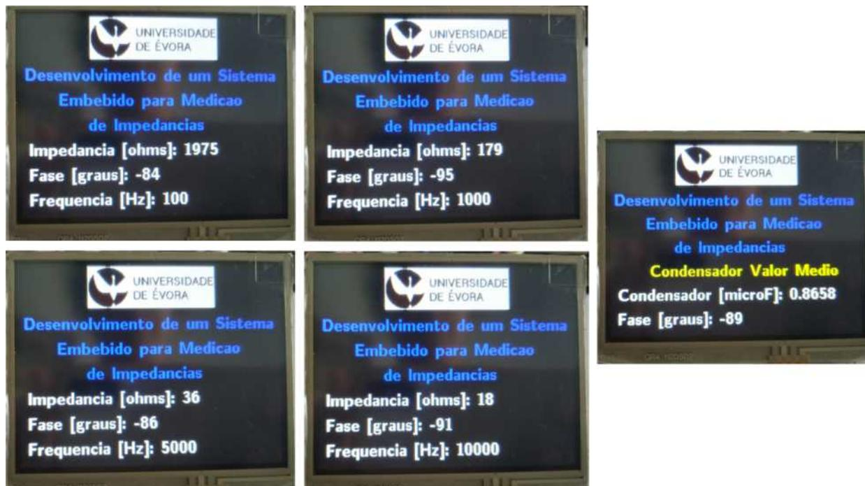
Figura 30: Apresentação no LCD dos resultados da medição de impedância e fase para o condensador de  $1 \mu\text{F}$
