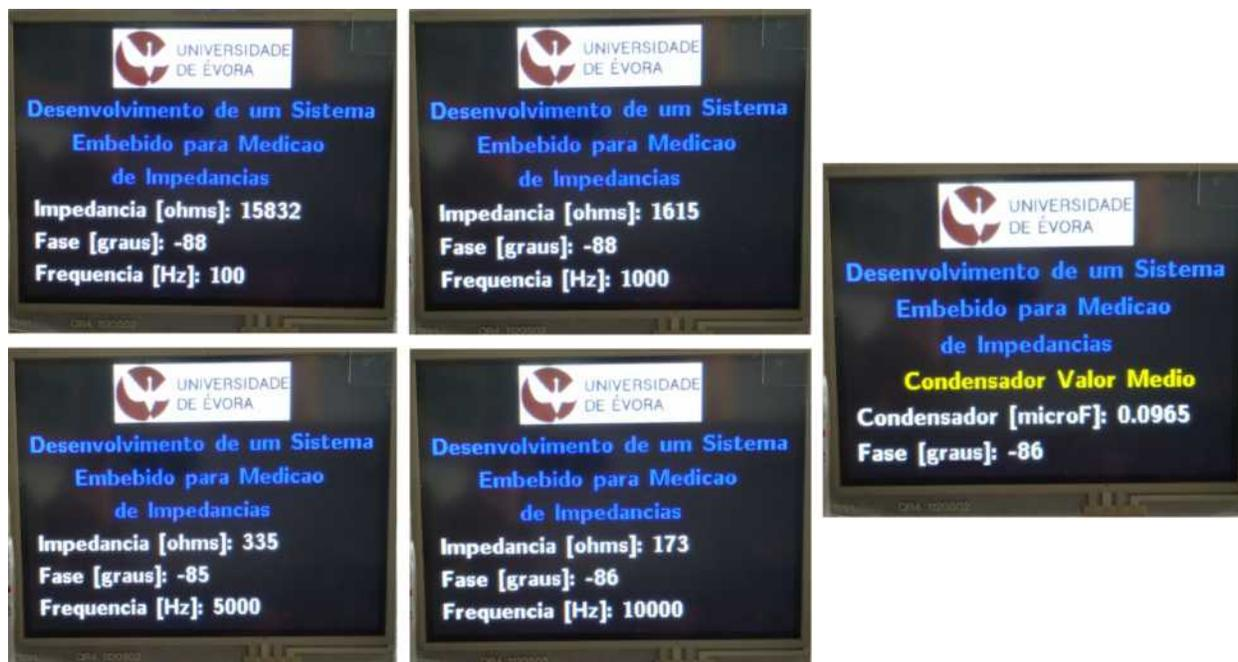
Figura 29: Apresentação no LCD dos resultados da medição de impedância e fase para o condensador de 0.1 μF
