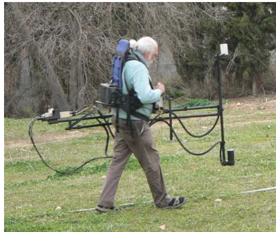
Figura 2.30: As imagens mostram o esquema de funcionamento de um magnetómetro de bombeamento ótico (1-4). A imagem inferior mostra uma aquisição de dados com um equipamento de dois sensores (gradiómetro).
