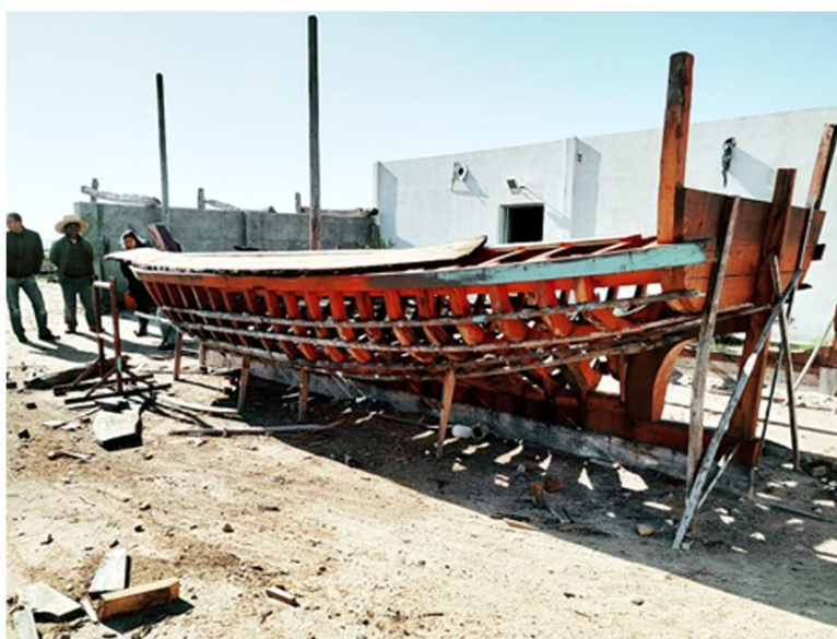
Annexe n° 4 – Chantier naval à ciel ouvert, îles Kerkennah. Bateau en construction.
