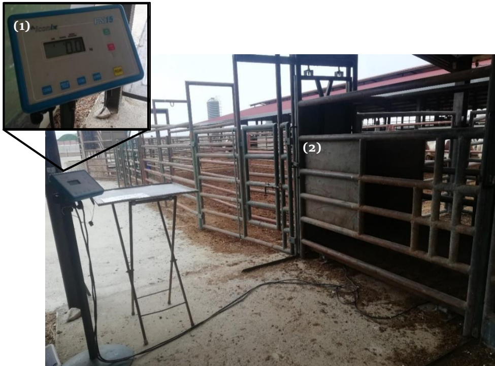
Figura 14 – Local das pesagens com o tronco de contenção com bscula fixa para pesagem dos animais (Fonte: Elaborao prpria). Legenda: (1) Balana eletrnica Iconix FX15; (2) Tronco conteno.
