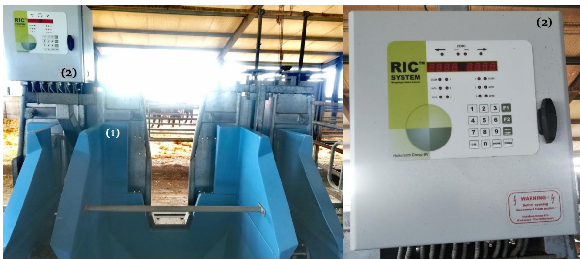
Figura 10 – Aspeto geral do comedouro com sistema RIC® (Fonte: Elaboração própria). Legenda: (1) Comedouro com balança fixa na base; (2) Caixa de controlo do sistema de alimentação RIC®.
