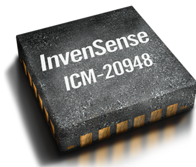
Figura 3.1: Exemplo do MEMS utilizado no estudo. Fonte: https://www.invensense.com/products/motion-tracking/9-axis/icm-20948/
