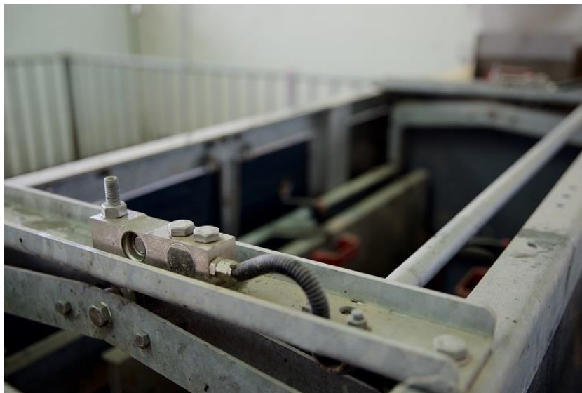
Figura 15 - Células de carga das máquinas de alimentação automática (Fonte: Elaboração própria)
