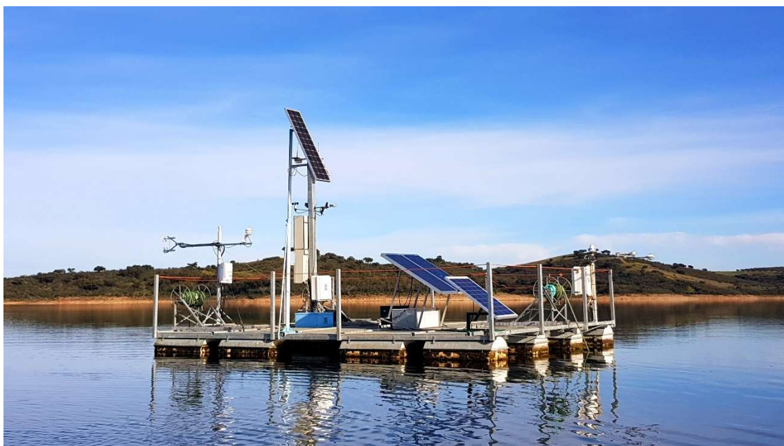
Figura 2.7 - Estação Meteorológica instalada numa plataforma flutuante sobre o lago, Montante . Fonte: Carolina da Purificação.
