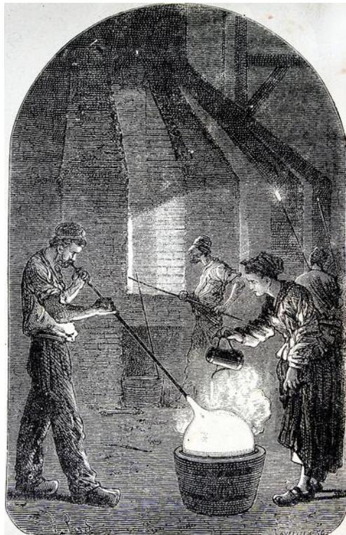
Fig 03 : Dessin qui met en scène un verrier qui souffle dans une canne en bois afin de grossir la paraison.
