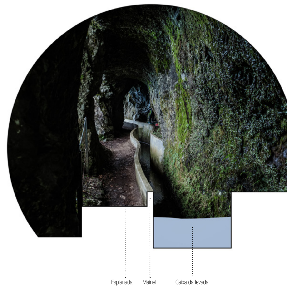
120 | Esquema da tipologia geral das levadas
