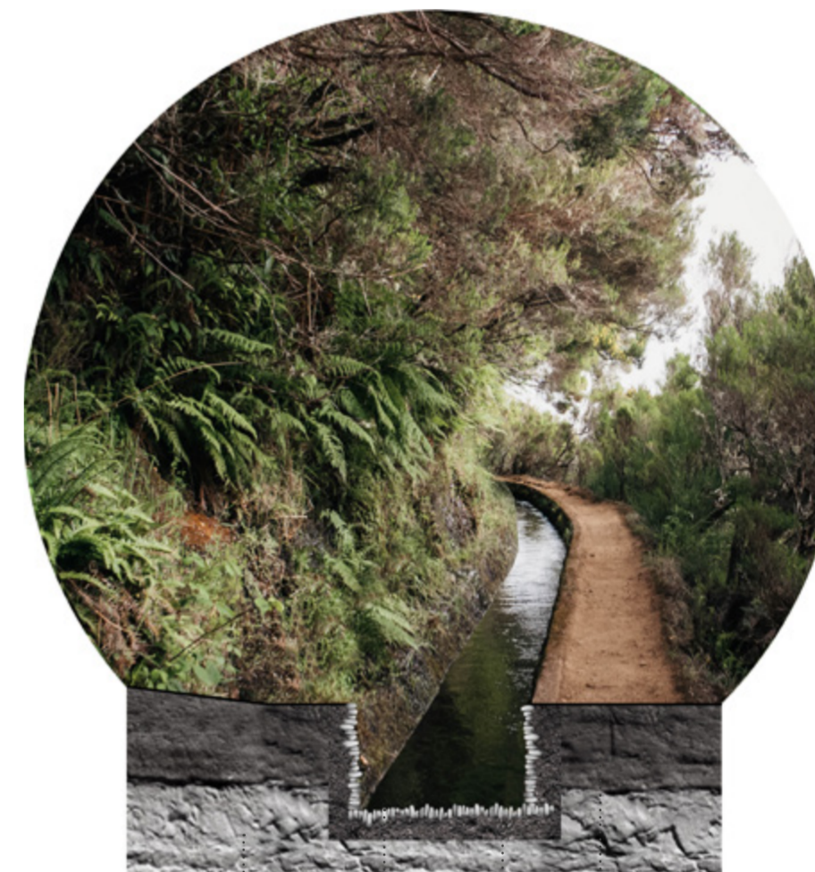
123 | Fotomontagem da tipologia das levadas revestidas em terra
