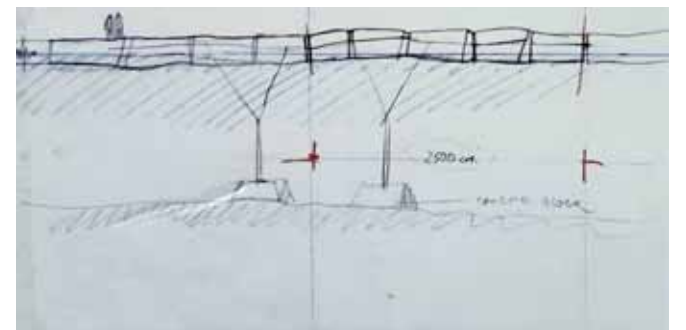
110. Primeiro estudo para a fixação dos cais ao fundo do rio. Uma aproximação da paisagem à escala do pormenor construtivo. "2000 metres wrapped, inflated piers. Rio de La Plata, Argentina. Christo y Jeanne-Claude. 1969. não construído (fonte: Christo and Jeanne-Claude, The floating piers, lake Iseo, Italy, 2014-2016. Taschen. p.6)
