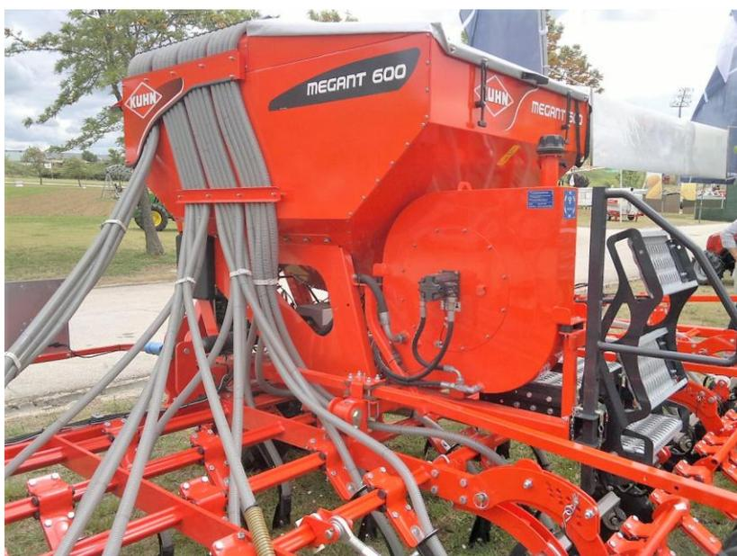
**Semeador Kuhn Megant 600, sendo visível o motor hidráulico ligado ao SESH do trator para actuar o ventilador.**
