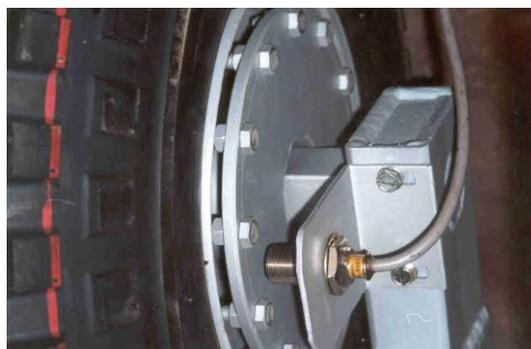
Entre uma instrução de entrada e de saída (dada pelo operador) o CPU realiza a contagem de voltas da roda a qual está associada o sensor de proximidade. Tendo sido, previamente introduzido no CPU o perímetro da roda, este efectua os cálculos da distância percorrida entre as duas instruções, a qual é transmitida ao monitor.
