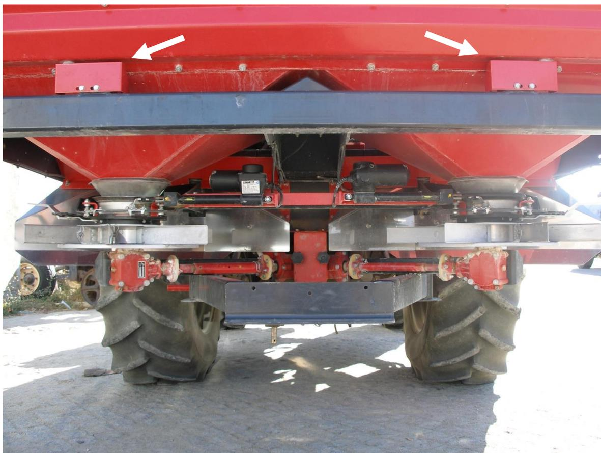
**Localização de células de carga no distribuidor centrífugo de adubo Vicon Rotaflow RS EDW.**
