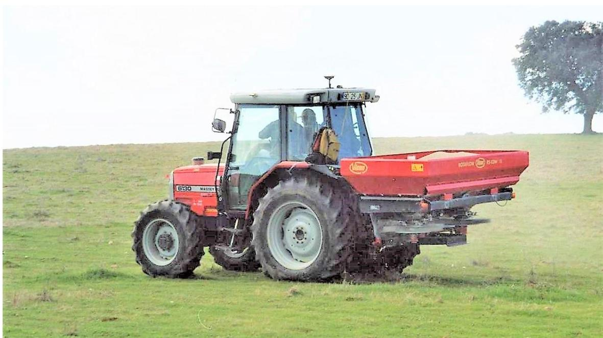
**Tractor Massey Ferguson 6130 e distribuidor centrífugo de adubo Vicon Rotaflow RS EDW.
