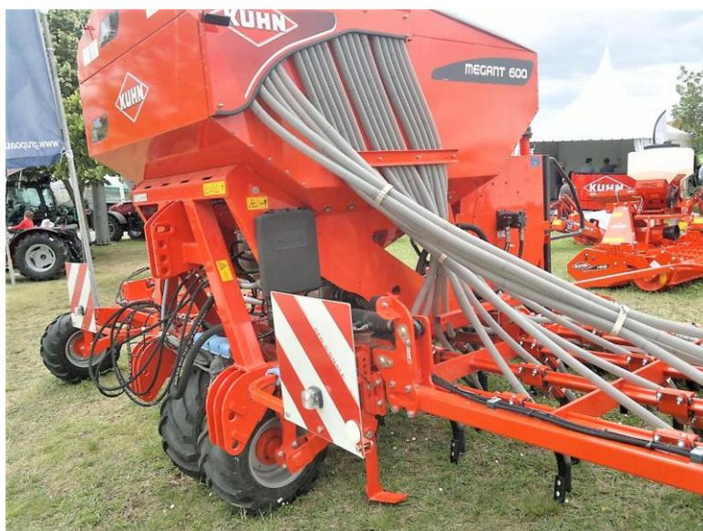
**Semeador Kuhn Megant 600, sendo visível o cabeçote de ligação ao tractor, a tremonha e os tubos de plástico condutores da semente, um por cada linha**
