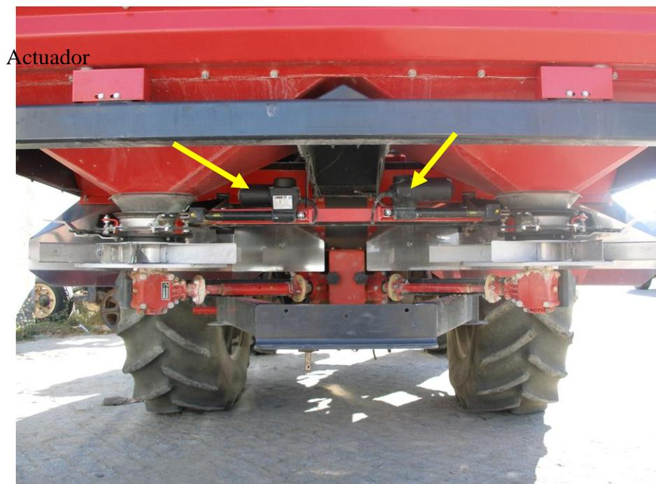
**Localização dos actuadores lineares electro-mecânicos no distribuidor centrífugo de adubo Vicon Rotaflow RS EDW.**
