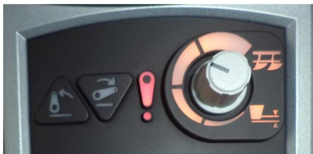
O sistema ilustrado na figura seguinte permite monitorizar a posição dos braços inferiores do sistema hidráulico do tractor, parâmetro importante quer na selecção de controlo de posição quer de controlo de esforço de tracção.
