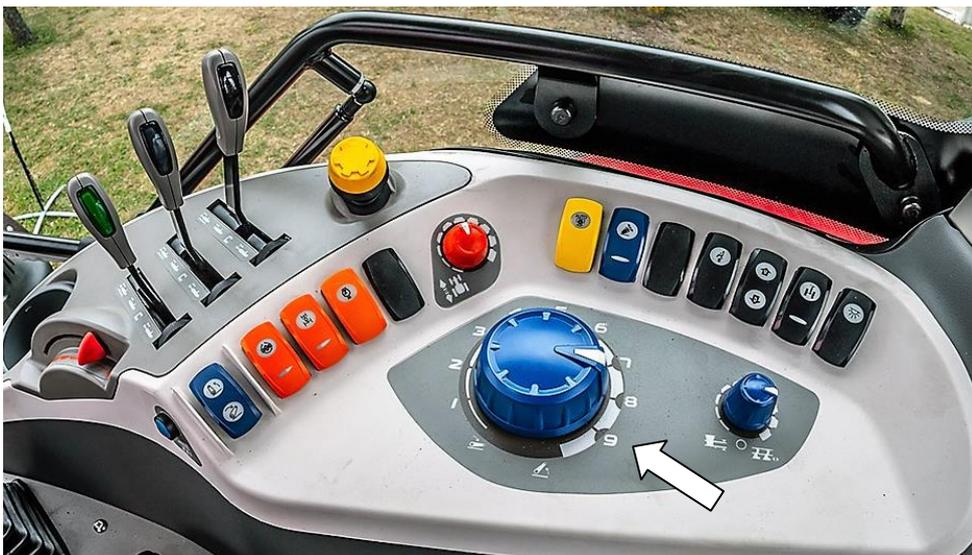
Potenciómetro de comando do ELC de um tractor McCormick
