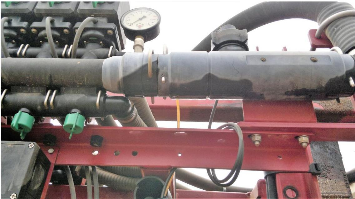
**Pormenor da caixa do medidor de caudal (debímetro) no pulverizador HARDY
