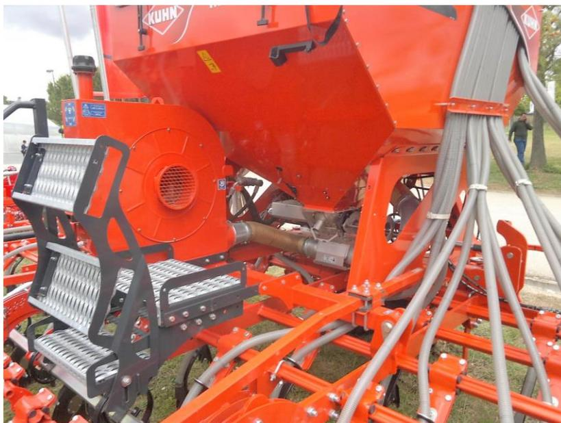
**Semeador Kuhn Megant 600, sendo visível a tremonha, o mecanismo doseador de semente (cilindro canelado), situado na base da tremonha e o ventilador que gera a corrente de ar onde são as sementes.**
