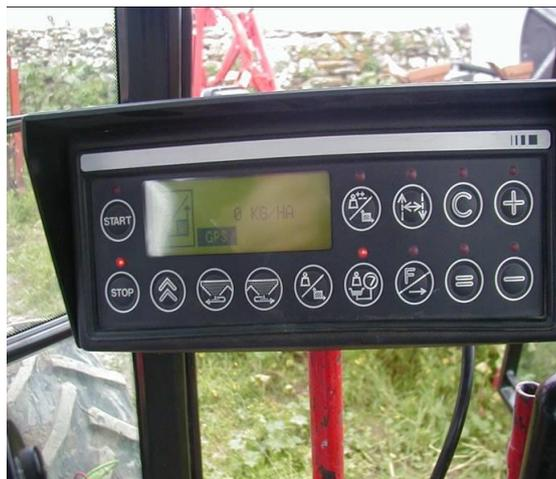
**Painel de monitorização e controlo (Ferticontrol) do distribuidor centrífugo Vicon Rotaflow RS EDW**
