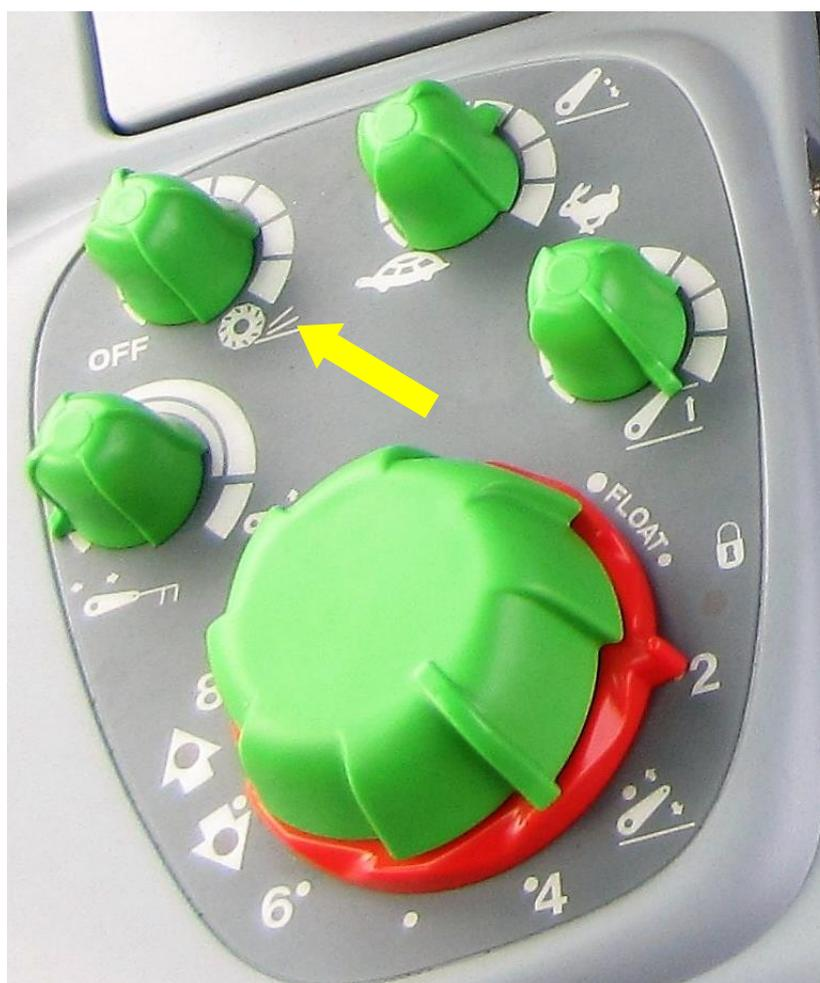
**Painel de comando do sistema hidráulico dos 3 pontos de um tractor SAME**
