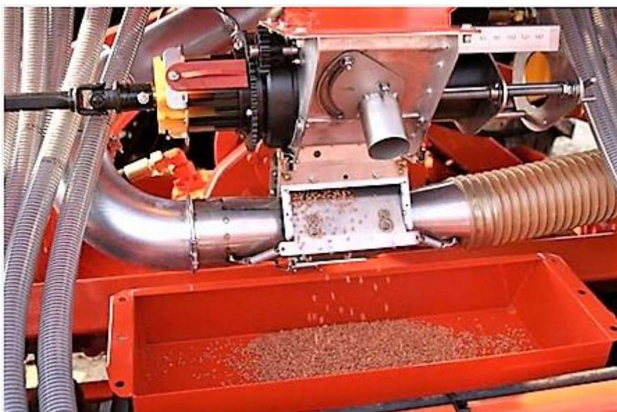
Tabuleiro de recolha de semente no processo de calibração
