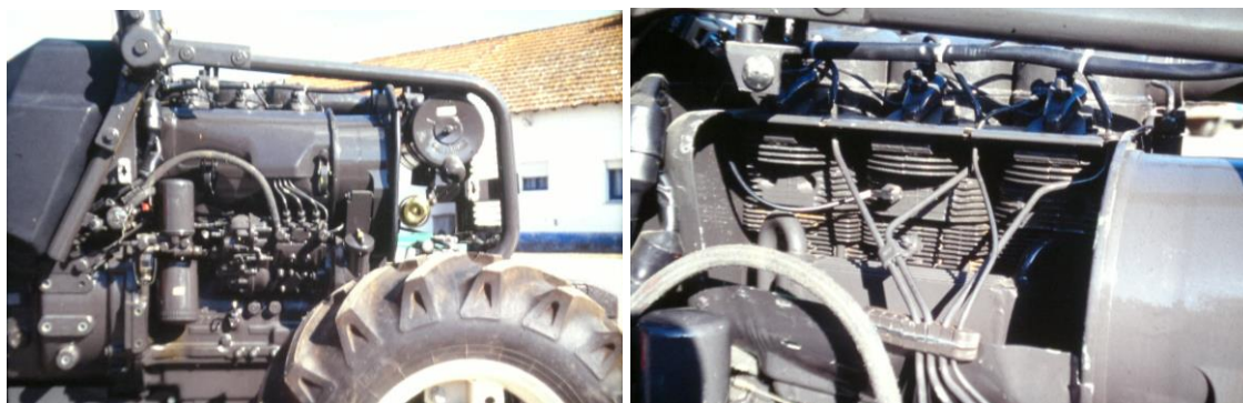
Tractor Carraro 6100F, vendo-se à direita o pormenor das alhetas de arrefecimento da cabeça e cilindros, após ter sido retirada a tampa da caixa de ar.
