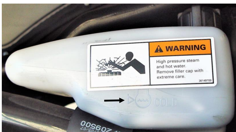
Vaso de expansão, com a indicação do nível correcto. Tractor Vatra N85 – Tractores e Equipamentos Automotrizes 2010/2011AS gre
