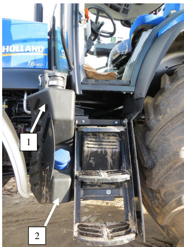
1 – Depósito de combustível; 2 – Depósito de AdBlue®
