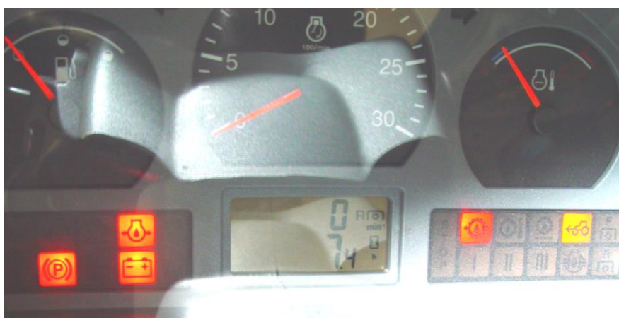
Sinais indicadores de falta de pressão de óleo
