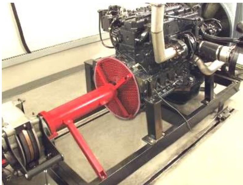
Ensaio de um motor Diesel (à direita) num freio dinamométrico (à esquerda)
