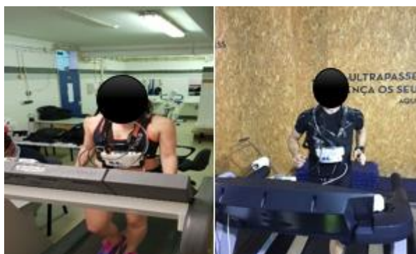
Figura 3: Exemplo de Sessão de EA com Analisador de Gases Portátil Cosmed K4b2
