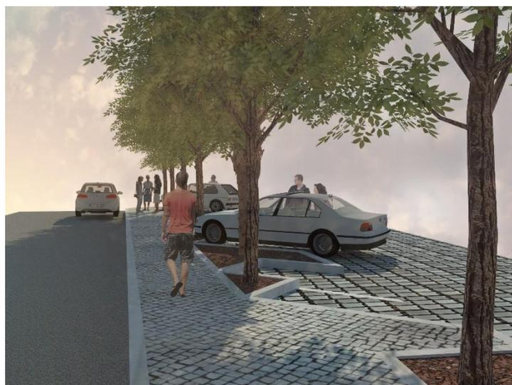
existentes e a drenagem natural do espaço, evitando a criação de drenagem artificial e, conseqüentemente, o aumento dos custos inerentes. O pavimento foi criteriosamente escolhido – Pavês Ecológico Quadrado, da PRESDOURO – com um grau de permeabilidade superior a 30% (Ver Anexo V – 8).
