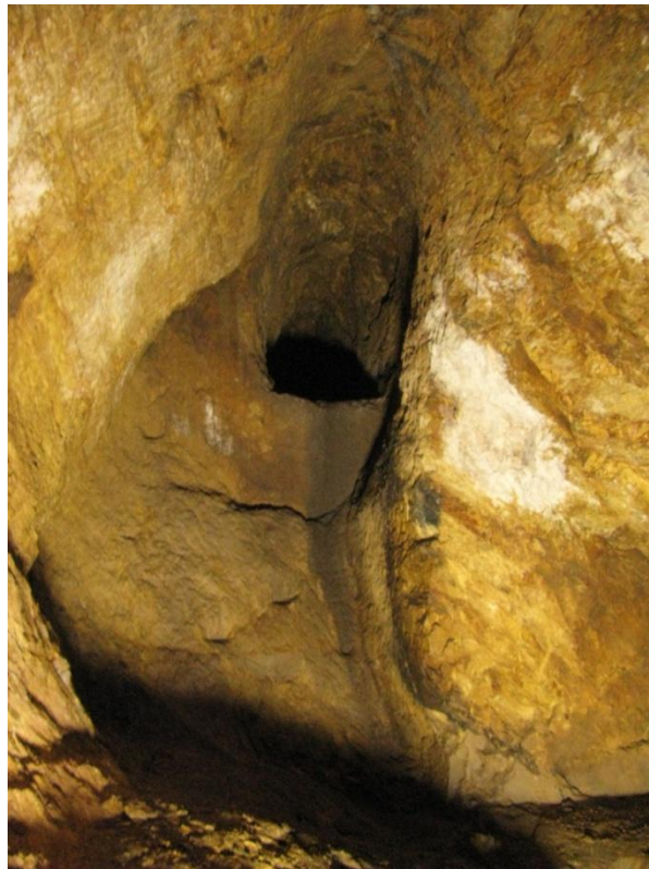
Foto 32 – Mina da Gralheira, galeria principal com desmontes laterais
