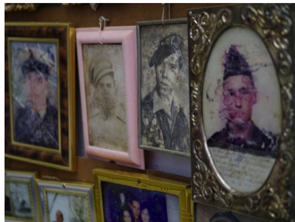
Figura 2 - Deterioração da gelatina, perda de corantes, fungos, desvanecimento e amarelecimento. Elaborado pela autora.
