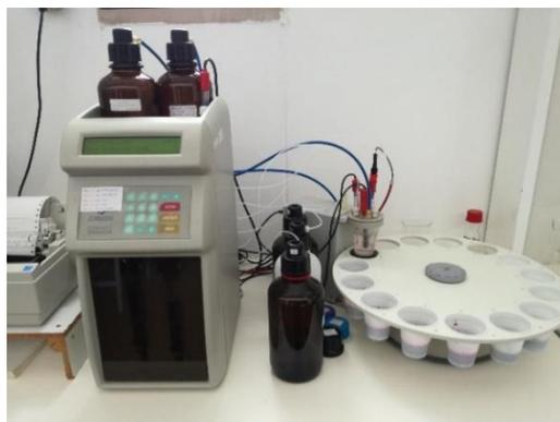
**Figura 9.** Potenciômetro utilizado nas análises.
