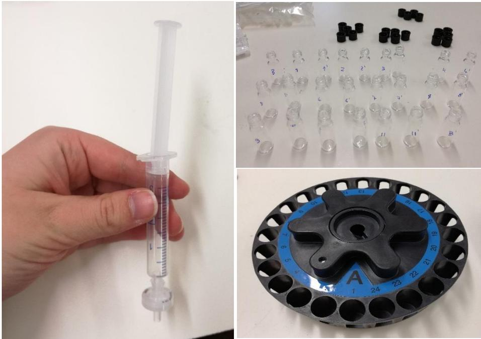
**Figura 10.** Filtração das amostras para tubos de HPLC.
