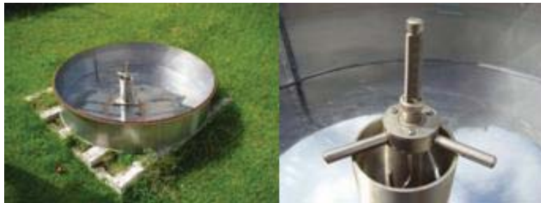
Figura 8.1 Tina evaporimétrica de classe A e pormenor do poço amortecedor com respetivo parafuso micrométrico.
