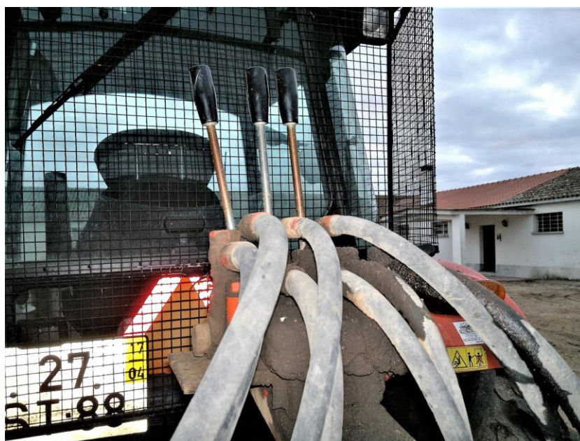
Figura 47 – bloco com 3 válvulas direccionais e respectivas alavancas de comando
