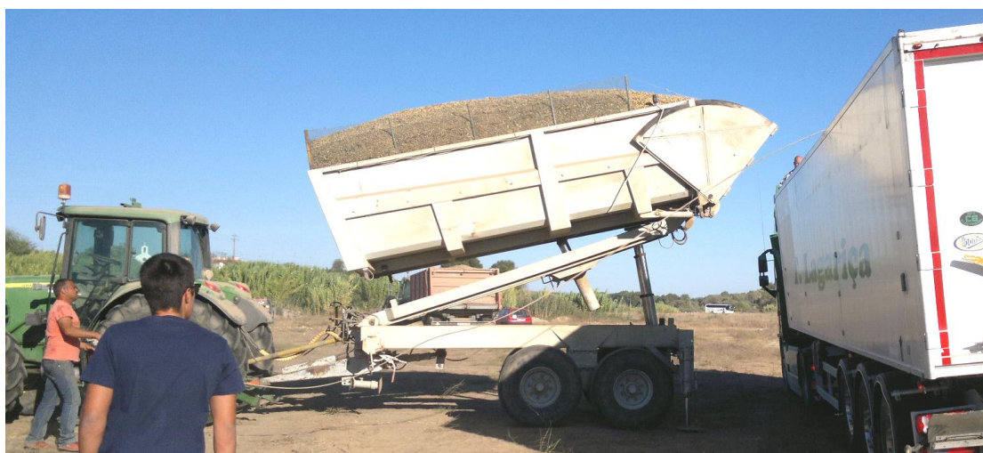
Figura 53 - Semi-reboque basculante de transbordo descarregando amendoim para veículo de transporte. A imagem mostra a actuação dos cilindros hidráulicos, actuados em paralelo , de levantamento da base da caixa. Visita para observação de colheita de amendoim (Couço) no âmbito da u.c. de Tractores e Equipamentos Automotrizes 2017.
