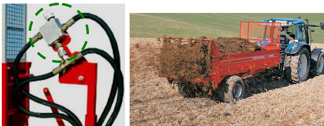
Figura 42 - Válvula de regulação de caudal inserida no circuito de um motor hidráulico (não visível), a qual permite variar a velocidade de translação do fundo móvel de um semi-reboque distribuidor de estrume, possibilitando, assim, regular a densidade de distribuição do estrume (ton/ha).
