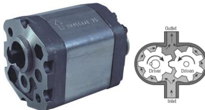
Figura 18 - Bomba de óleo de carretos (aspecto exterior e interior)
