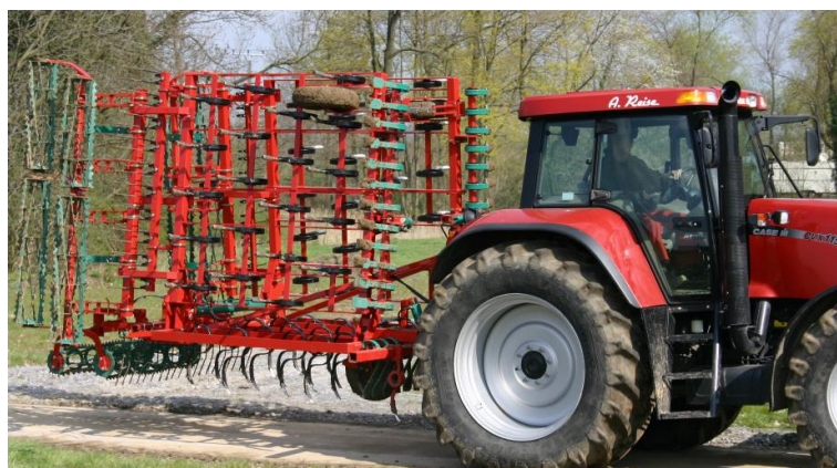
Figura 26 - Os dois cilindros hidráulicos assinalados, actuados em paralelo , rebatem o corpo do lado esquerdo do vibrocultor. Um segundo par de CHDE actuados em paralelo rebate o corpo direito http://kvernelandgroup.papirfly.no
