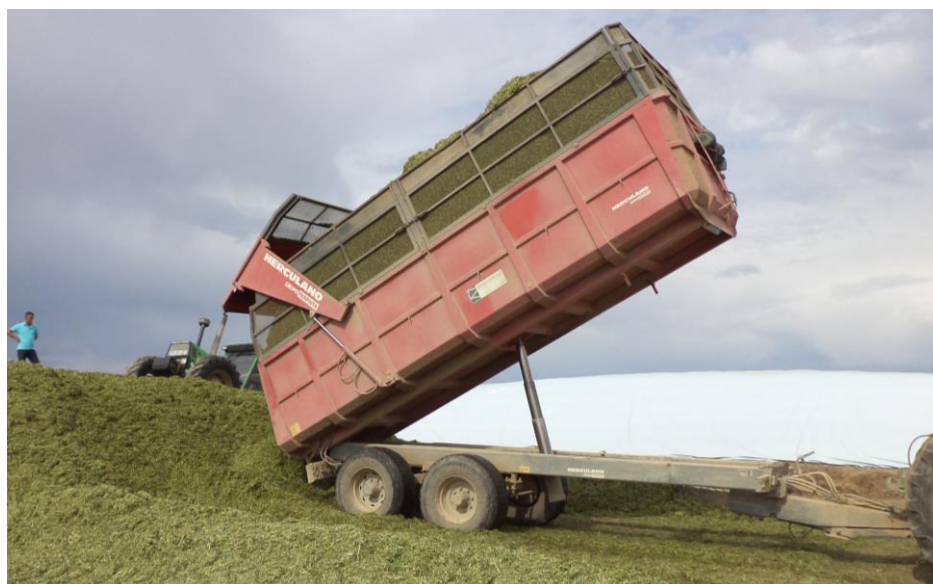
Figura 29 - O semi-reboque ( farm trailer ) da figura dispõe de um CHSE para rebater ( tip ) a caixa; O peso da caixa fará recolher a haste do cilindro.
