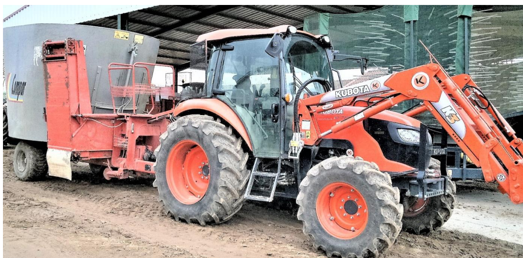
Figura 44 – Semi-reboque misturador e distribuidor de ração ( mix feeders ) são exemplos frequentes de equipamentos com sistema hidráulico autónomo
