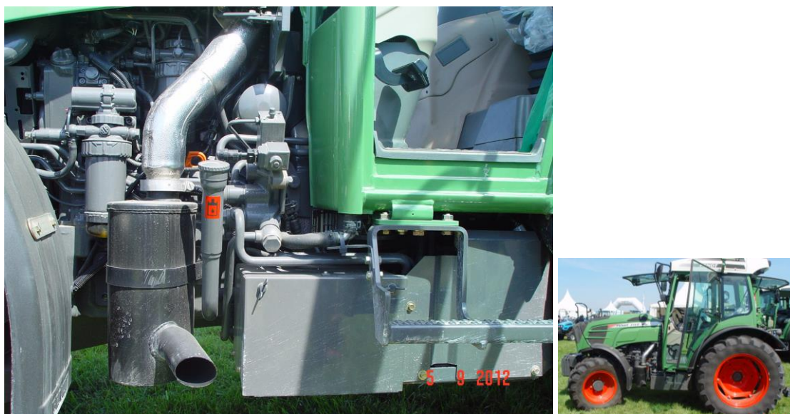
Figura 16 - Reservatório de óleo do sistema hidráulico de um tractor FENDT 211F. Notar o símbolo de óleo de hidráulico colocado no bujão de enchimento.
