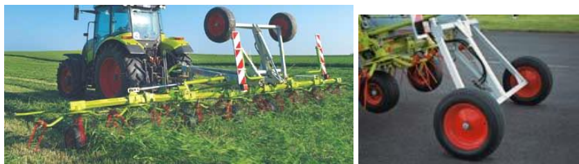
Figura 27 - O virador de feno ( trailed tedder ) da figura, possui um CHDE para actuar as rodas de transporte ( transport wheels ) e um par de CHDE, em paralelo, para o rebatimento dos corpos laterais ( folding wings ). www.claas.com
