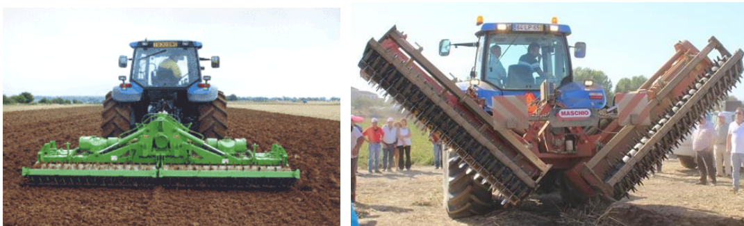
Figura 25 - Dois CHDE em paralelo rebatem os corpos da grade rotativa para a posição de transporte
