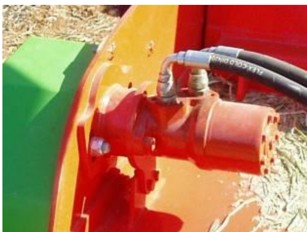
Figura 34 - Motor hidráulico de accionamento de órgãos activos de uma trituradora de rama de poda
