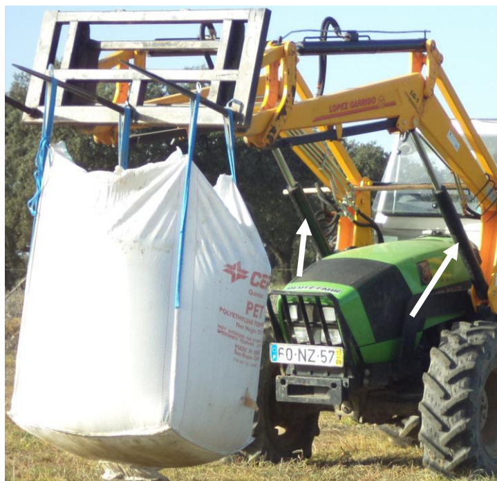
Figura 32 - Um par de CHDE actuados em paralelo rebate a lança do carregador frontal. Para o mesmo caudal, os CHDE encolhem mais depressa do que estende; para uma mesma pressão, os CHDE exercem maior força a estender do que encolher. Como consequência o carregador tem mais força para levantar carga e desce mais depressa para o solo. Tractores e Equipamentos Automotrizes 2014.
