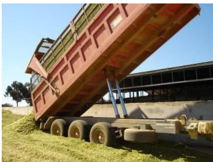
Figura 31 - Semi-reboque basculante com caixa rebatida por dois cilindros hidráulicos de simples efeito (CHSE), em paralelo. Tractores e Equipamentos Automotrizes 2011/12 – Visita à herdade dos Padres
