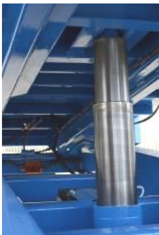
Figura 30 - Cilindros telescópico para possibilitar que, quando recolhida, a haste ocupe o menor espaço possível.
