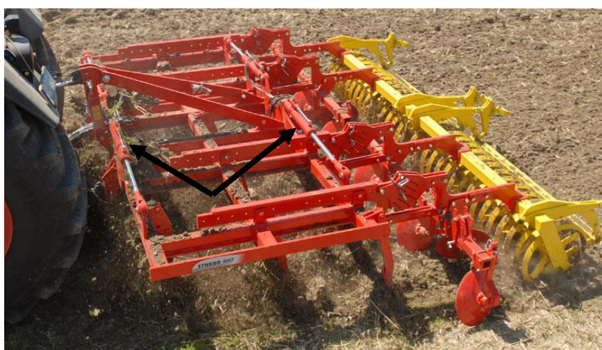
Figura 25 - Dois CHDE em paralelo rebatem os corpos da grade rotativa para a posição de transporte
