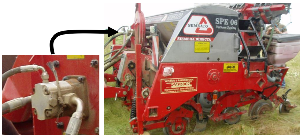
Figura 35 - Motor hidráulico de accionamento do ventilador de um semeador mono-grão, pneumático, de sementeira directa. Controlo de Equipamentos e Mecanização Aplicada -visita de estudo à herdade da Lobeira (Ciborro)
