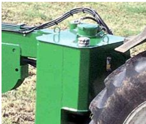
Figura 15 - Reservatório de óleo do sistema hidráulico autónomo de uma máquina de revestir fardos de feno-silagem em película plástica http://www.mchale.net/
