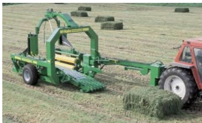
Figura 51 - enrolador de fardos em película plástica www.mchale.net
