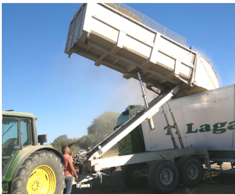
Figura 54 - Semi-reboque basculante de transbordo descarregando amendoim para veículo de transporte. A imagem mostra a actuação do cilindro hidráulico de rebatimento da caixa. Visita para observação de colheita de amendoim (Couço) no âmbito da u.c. de Tractores e Equipamentos Automotrizes 2017.
