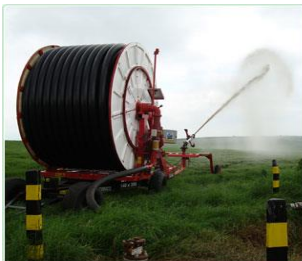
Figura 39 - Exemplo de rega por canhão com enrolador na parcela Quartijos (Fonte: http://www.traxco.pt , 2016).
