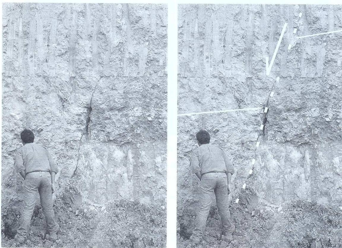
Fig. 6 – Falha normal (N 5°E; 80°W) em sedimentos terciários, 2 km a SW de Juromenha. Na imagem do lado direito indica-se a componente normal do movimento, associada a uma separação vertical métrica.
