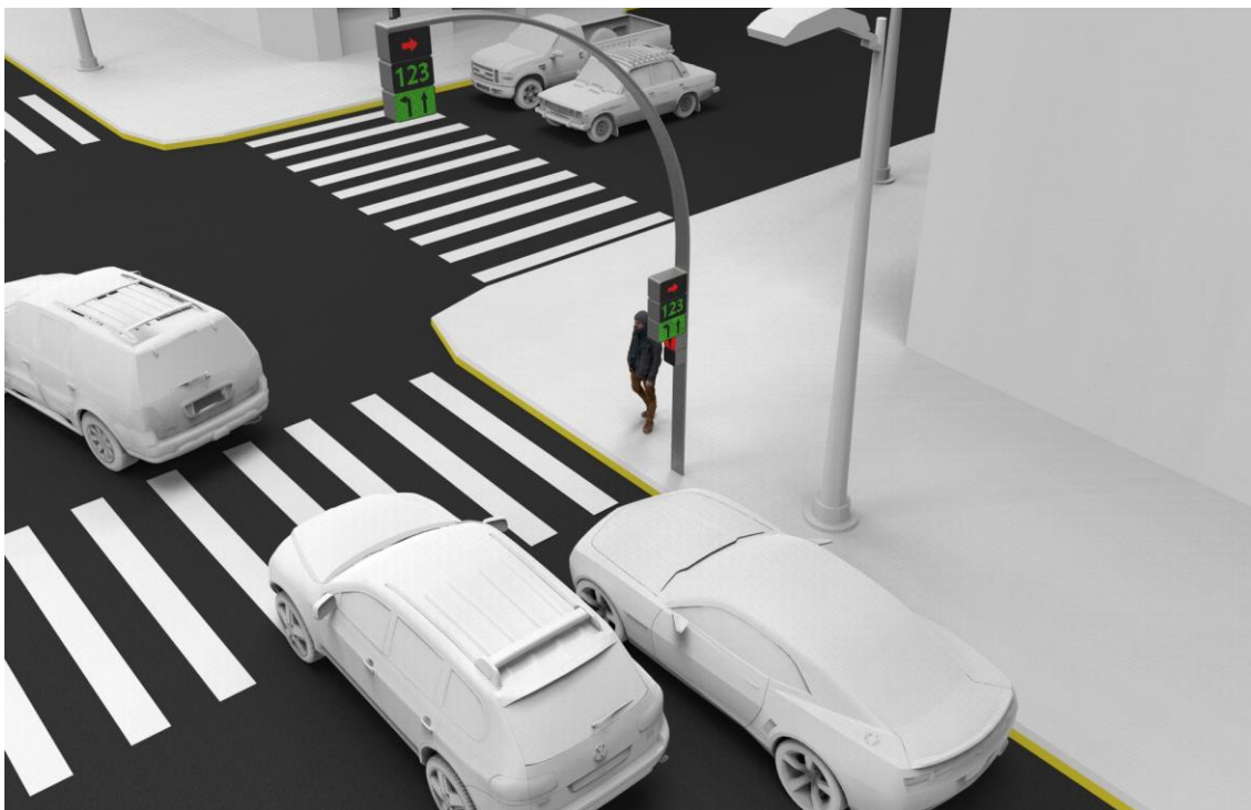
Figura 42 – Render de simulação de funcionamento do semáforo
