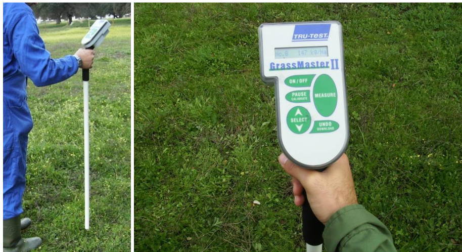
Figura 14. À esquerda, medição com a Grassmaster II; à direita, pormenor da consola.
