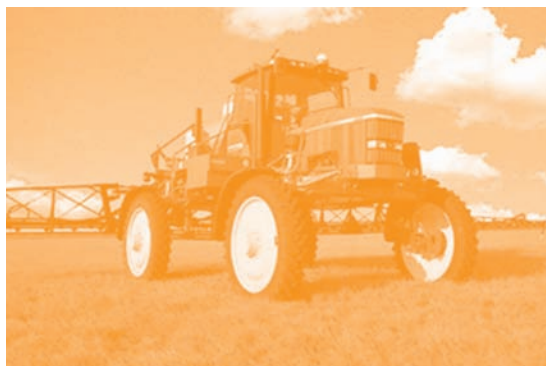
Figura 32 - Pulverizador VRT acoplado a tractor com antena de receptor GPS (Fonte: http://www.deere.com )
