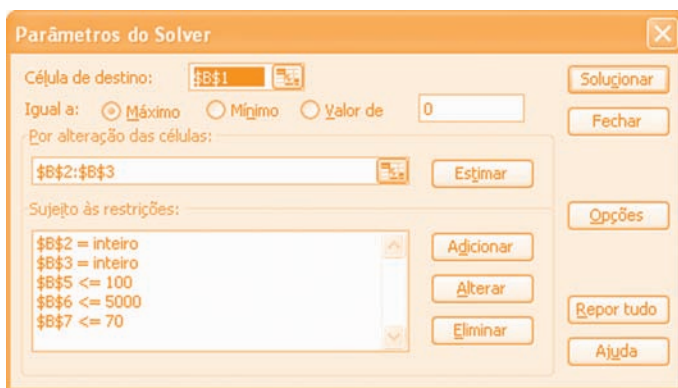
Figura 12 – Configuração dos parâmetros do Solver para os dados de entrada apresentados
