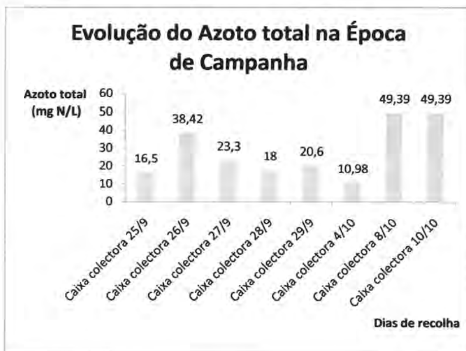
Figura 39: Evolução do Azoto total (mg N/L) durante os dias de recolha da Época de Campanha.
