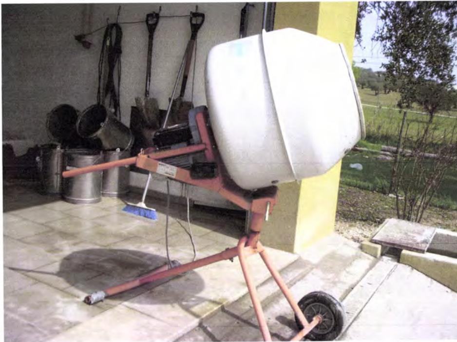
Figura 2- Misturadora utilizada na produção dos betões
