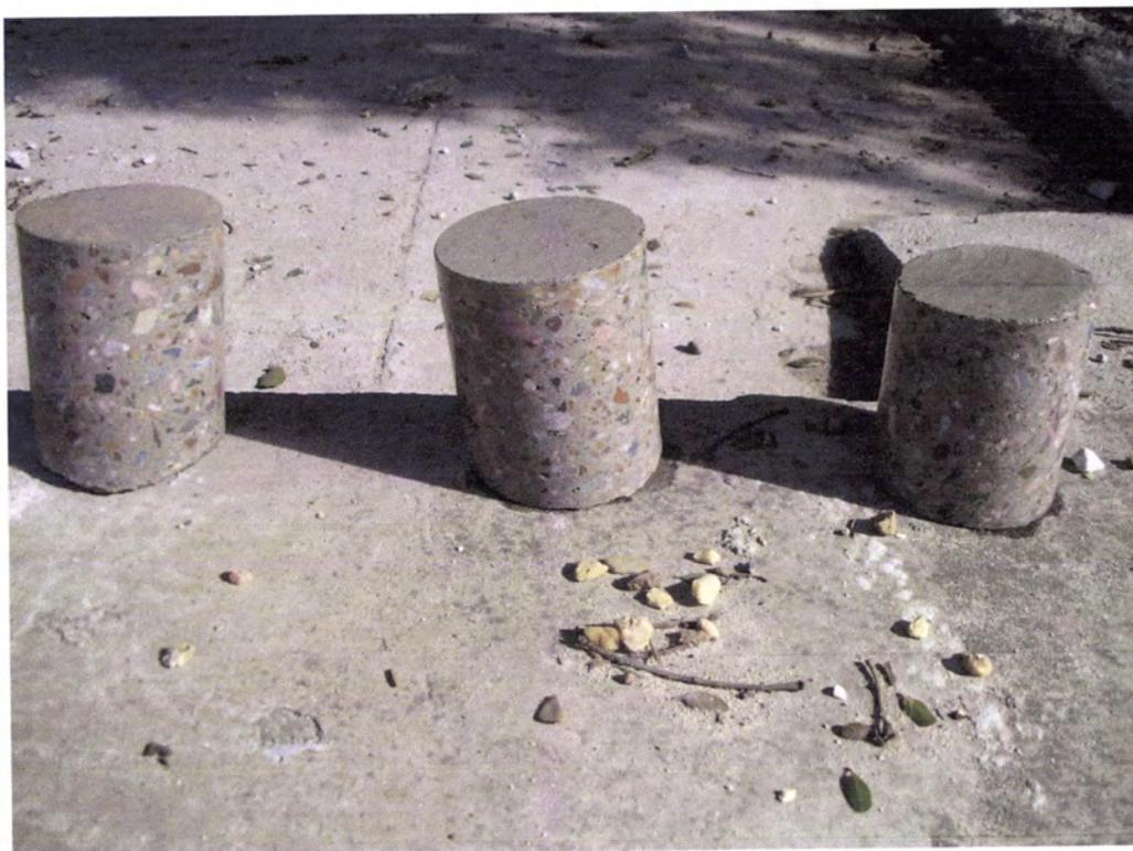
Figura 16 - Carotes extraídas do Protótipo
