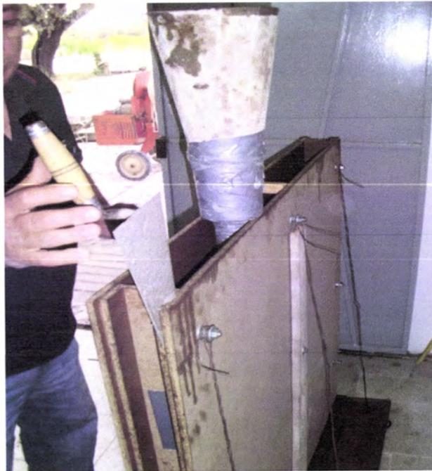
Figura 13 - Cone de Abrams acoplado com um tubo
