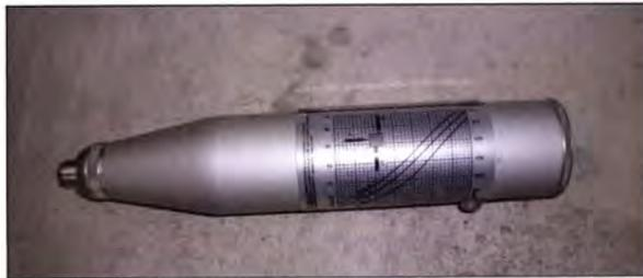
**Figura 4. 24** – Esclerómetro de Schmidt
