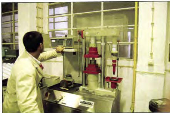
**Figura 4. 19** – Máquina de ensaio da resistência à compressão dos provetes cilíndricos
