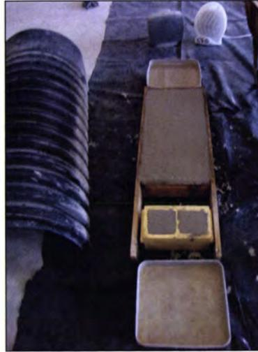
**Figura 4. 11** – Disposição da lajeta, tinas, e cubos de resistência à penetração
