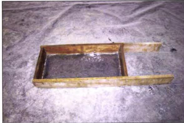
Figura 4. 4 – Cofragens com a dimensão  $300 \times 600 \times 100 \text{ mm}^3$
