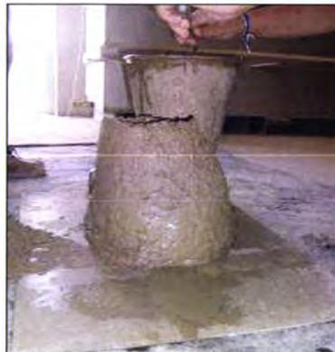
**Figura 4. 7** – Ensaio de abaixamento
