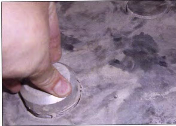
**Figura 4. 20** – Colagem da pastilha cilíndrica
