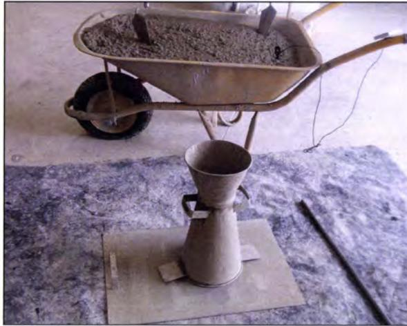
**Figura 4. 6** – Medição da temperatura da amassadura e cone de Abrams
