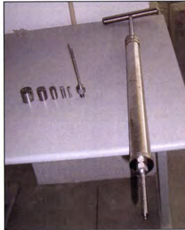
**Figura 4. 9** – Penetrometro e as secções da agulha
