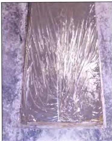
Figura 4. 16 – Colocação da película aderente sobre a lajeta
