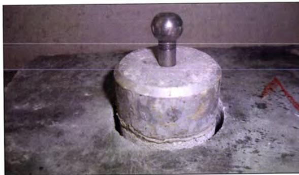
**Figura 4. 21** – Parafuso enroscado na pastilha
