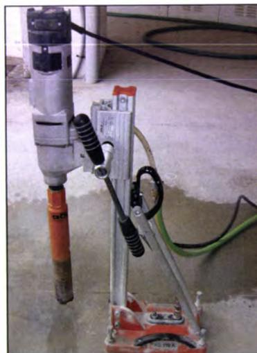
Figura 4. 18 – Caroteadora com broca de 50 mm de diâmetro
