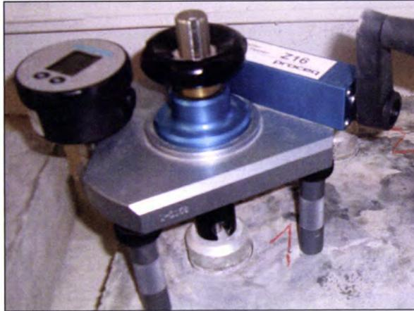
Figura 4. 22 – Aparelho para o ensaio de Pull-Off, ajustado ao parafuso
