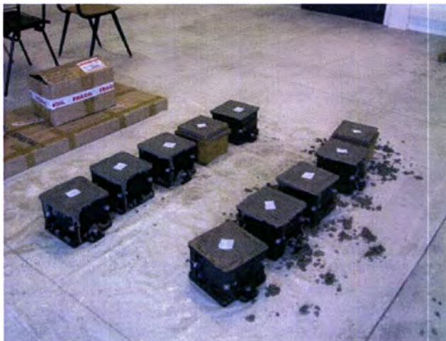
Figura 4.1 – Aspecto das amostras após colocação e vibração no respectivo molde.
