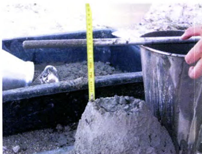
Figura 5.1 – Ensaio do Cone de Abrams – medição do abaixamento da amassadura.
