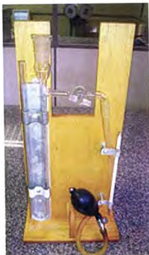
Figura 3.2 – Manómetro de vidro utilizado no método de Blaine.
