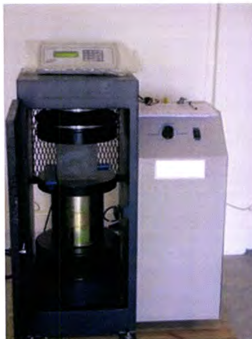
Figura 3.5 – Prensa utilizada na medição da resistência à compressão das amostras.
