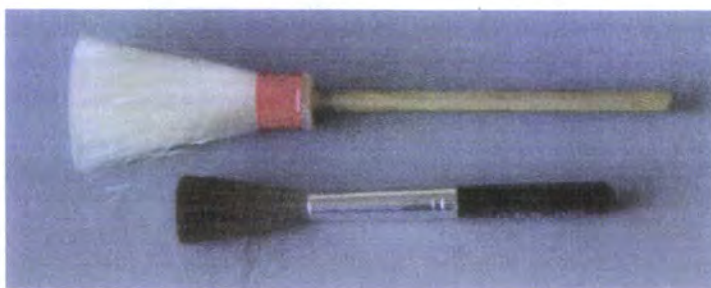
Ilustração da utilização da técnica do pó na revelação de ID, e pincéis (fibra de vidro e pêlo de camelo) (Fonte: Chemello, E. Química Virtual (2006) e Katz, D. Fingerprinting )
