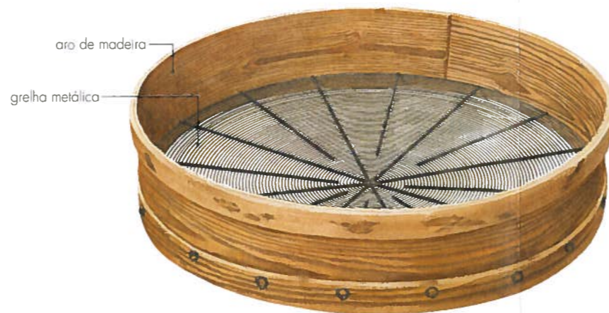
Crivo O crivo era usado para separar do cereal os detritos ou impurezas que pudessem comprometer a qualidade da farinha.
