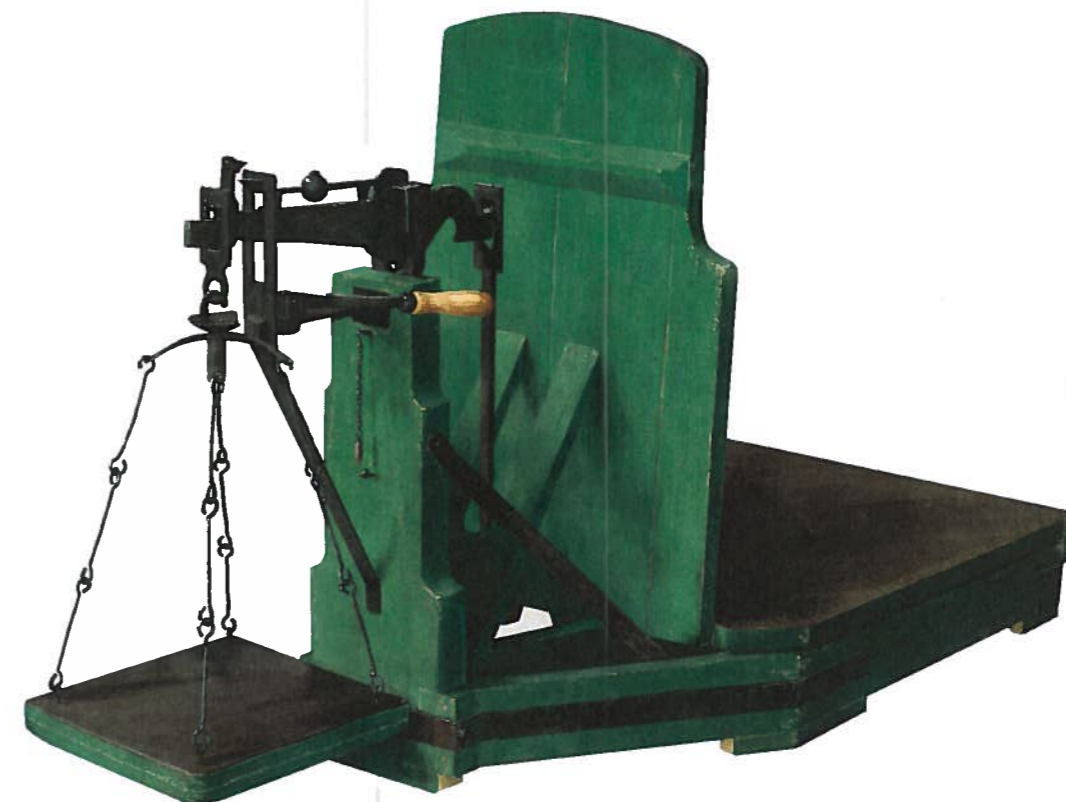
Balança O moleiro pesava o cereal numa balança decimal a fim de calcular a maquia a retirar para pagamento do seu trabalho.
