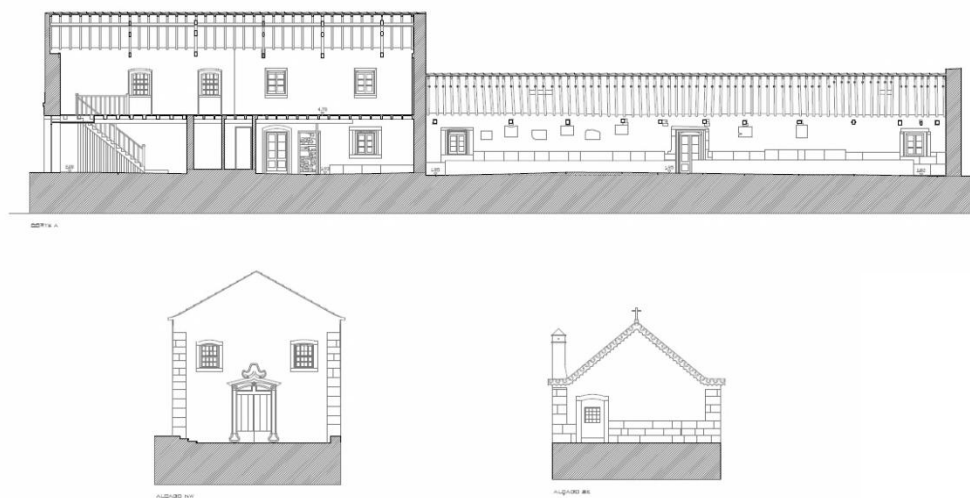
Figura 15 – Levantamento arquitetónico do Moinho de Corroios em formato dwg (elaborado pelo Atelier de Soraya Genin)
