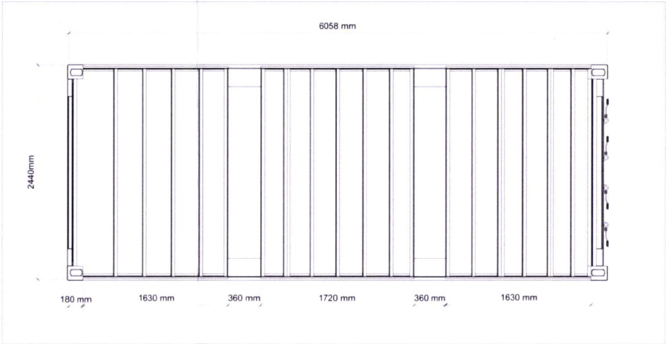
Fig.10 - Desenho técnico da Planta do Contentor
