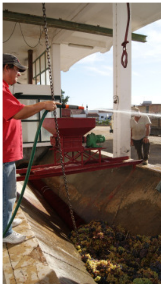
FIG. 94 "Sem-fim" no tégão da adega cooperativa de Lagoa.
