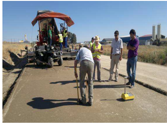
TRAMO DE PRUEBA COMPACTACIÓN Y DENSIDADES - HUMEDADES.
