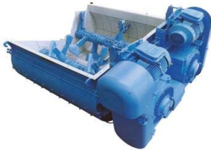
Figura 4.17 - Aspecto del interior de una amasadora de doble eje horizontal forzado.
