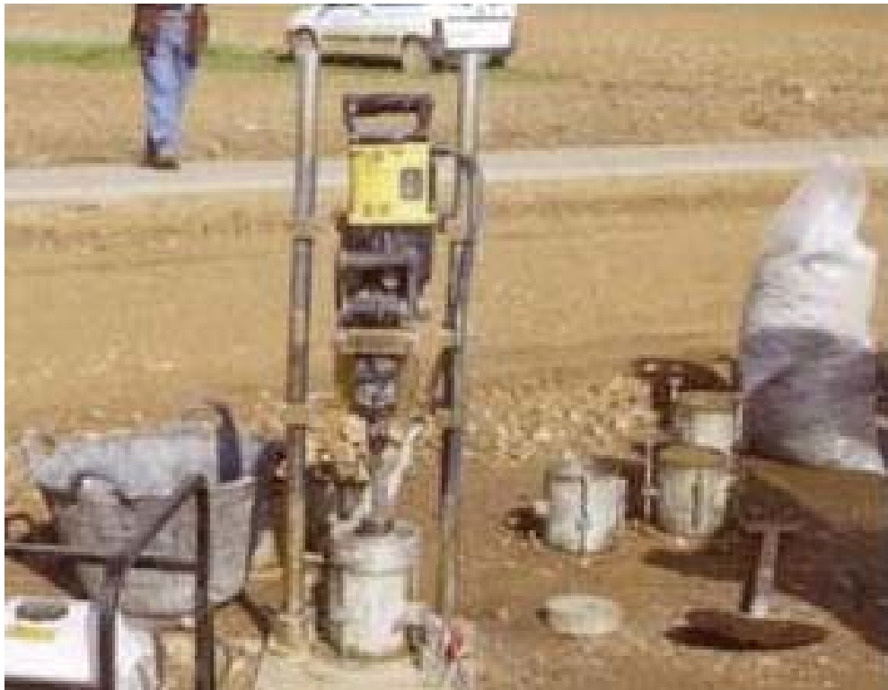
Figura 4.23 - Martillo vibrante con guías para la compactación de probetas en obra.
