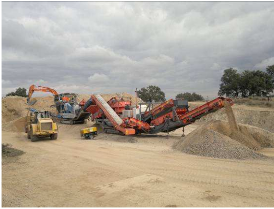
MACHAQUEO – FABRICACIÓN DE MATERIAL PARA SC.
