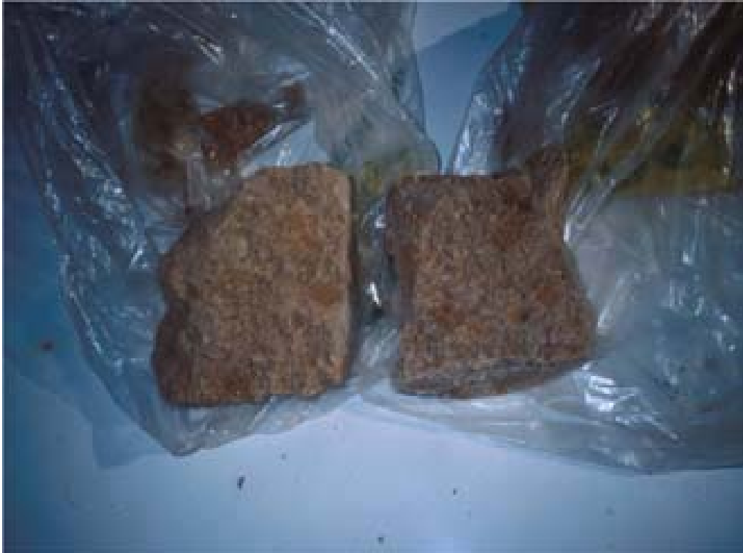
Figura 4.48 - Probetas de suelocemento con terrones de partículas plásticas no disgregadas.
