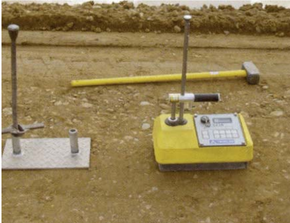
Figura 4.22 - Equipo nuclear, medidor de densidad y humedad de la capa.
