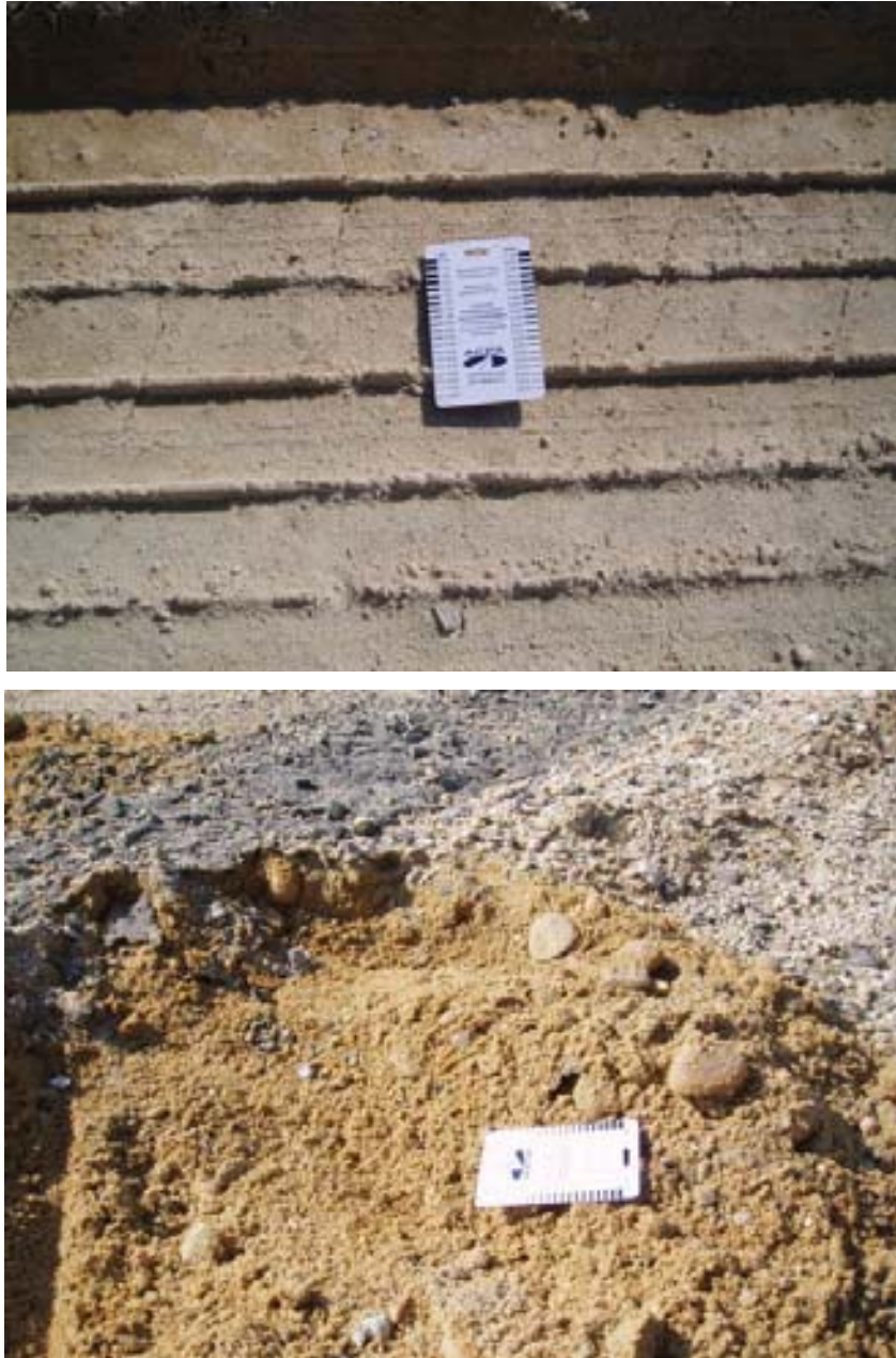
Figura 4.45 - Suelo muy fino sin estructura granular, no aconsejable para realizar suelocemento (Guía Técnica, 2014).
