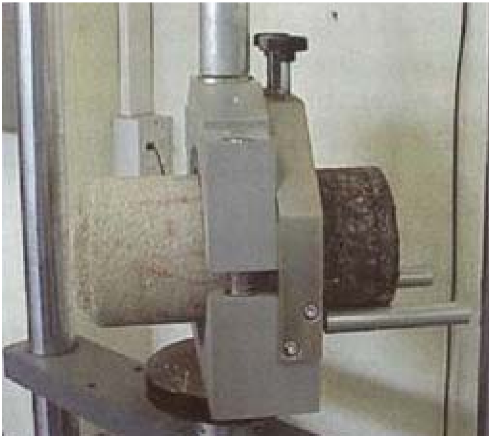
Figura 4.32 - Ensayo de compactación de la adherencia entre capas (Guía Técnica, 2014).
