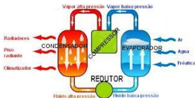
Figura 13. Esquema simplificado de um sistema de aquecimento por bomba de calor.
