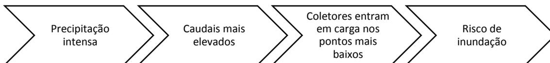
**Figura 2.10** A precipitação intensa gera caudais mais elevados, causando a entrada em carga dos coletores nos pontos mais baixos, contribuindo assim para o aumento do risco de inundação
