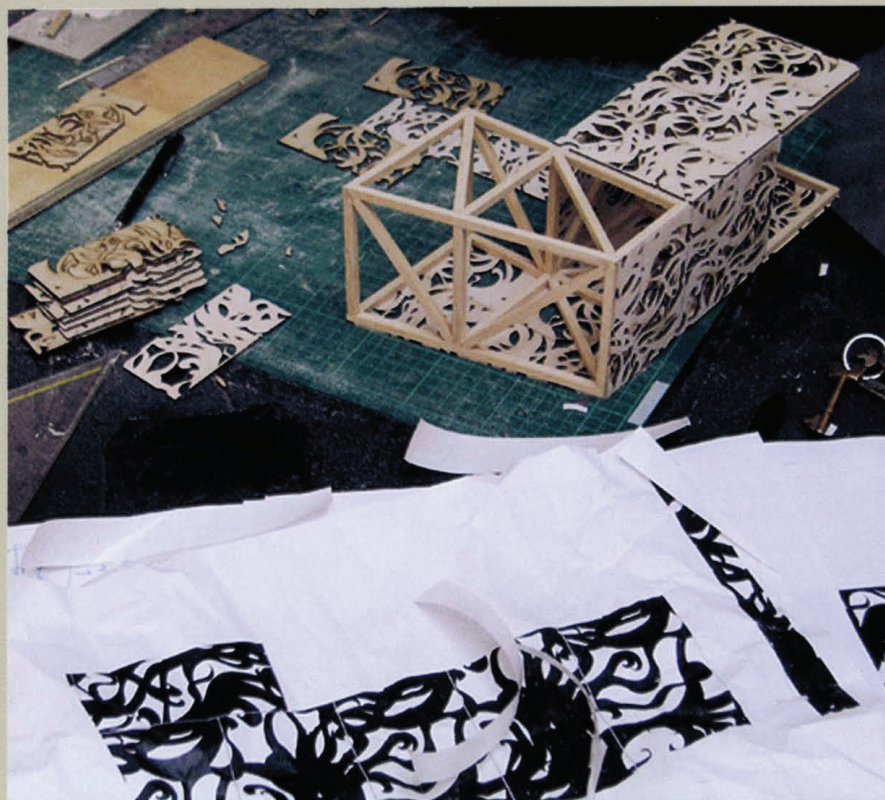
Maqueta inacabada a escala 1:20 de un pabellón temporal de 6a architects. Su intrincado diseño reproduce con exactitud el de la intervención final y utiliza el mismo proceso de fabricación, aunque a menor escala.
