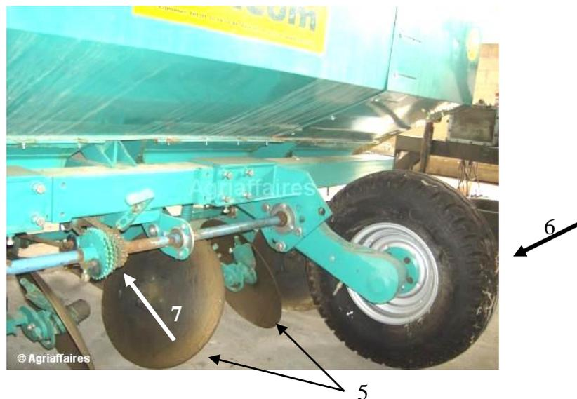
Uma roda de movimento (6) fornece movimento às diferentes linhas, através de uma transmissão (7) cuja relação pode ser alterada para permitir mudar o compasso entre túberculos na linha e consequentemente a densidade de plantação.
