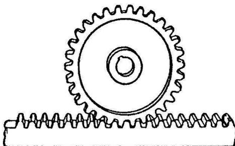
O dentado pode ser recto (*spur gear*) ou helicoidal (*helical gear*), tendo este último a vantagem de ser mais resistente e de ter um funcionamento mais silencioso.
