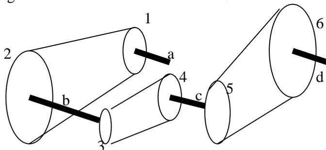
Admita: Roda 1 – 30 dentes; Roda 2 – 50 dentes; Roda 3 – 20 dentes; Roda 4 – 30 dentes; Roda 5 – 40 dentes; Roda 6 – 70 dentes Velocidade de rotação do veio a – 750rpm.
