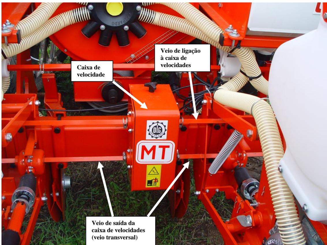
O veio transversal transmite, através de engrenagem cónica, movimento para o veio de transmissão para o prato de alvéolos (em cada corpo do semeador):
