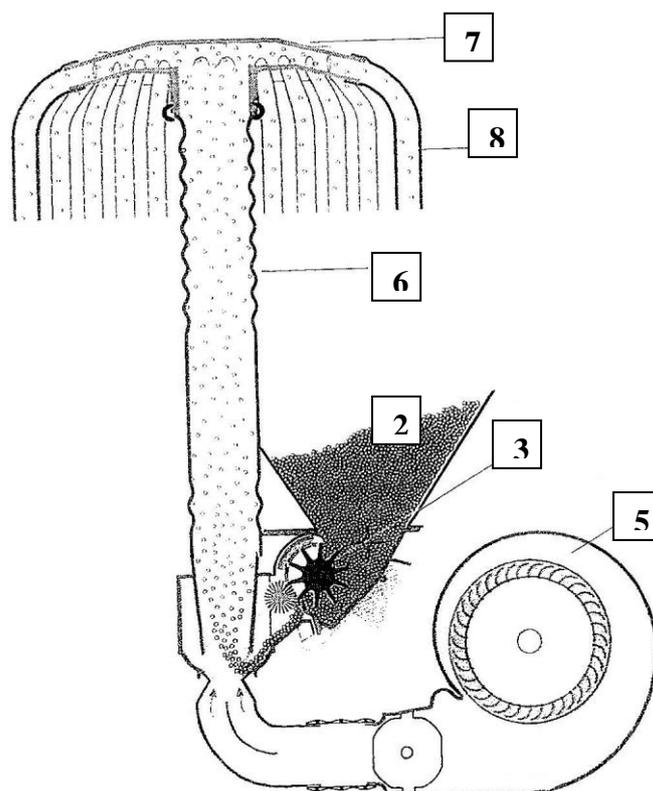
A semente contida numa tremonha (2) é doseada por um único mecanismo doseador/*metering cylinder* (3), sob a forma de um cilindro canelado e lançada numa corrente de ar (6) gerada por um ventilador (5). Um repartidor/*distributor* (7) divide o fluxo de ar (consequentemente as sementes) por cada um dos tubos (8), correspondendo cada tubo a uma linha do semeador
