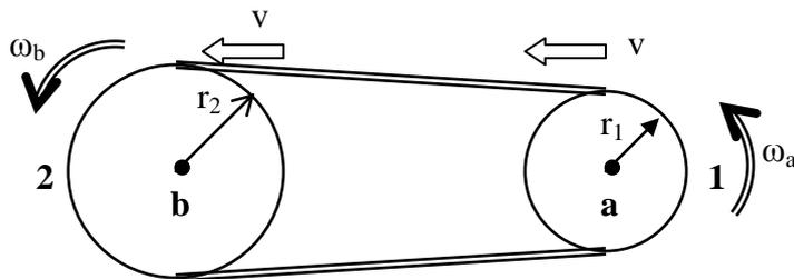
Seja  $r_1$  e  $r_2$  os raios das respectivas polias;  $\omega_a$  e  $\omega_b$  as velocidades angulares dos veios, em radianos por segundo (*rad/s*) e  $n_a$  e  $n_b$  as velocidades de rotação em rotações por minuto (*rpm*).
