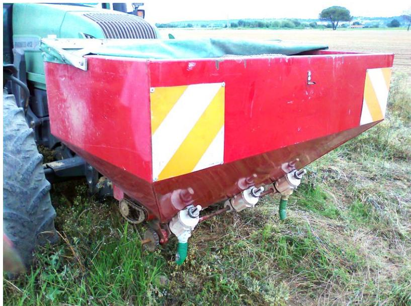
Lateralmente à caixa, encontra-se uma transmissão por corrente de rolos que parte de um veio (veio de entrada) onde estão montadas dois carretos, com 20 e 24 dentes. Cada uma dessas rodas transmite movimento para um veio:
