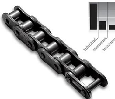
O elo exterior é constituído por duas chapas exteriores (*outer plates*) e os fuzis (*pins*). O elo interior é constituído por chapas interiores (*inner plates*), casquilhos (*sleeves*) e rolos (*rollers*).
