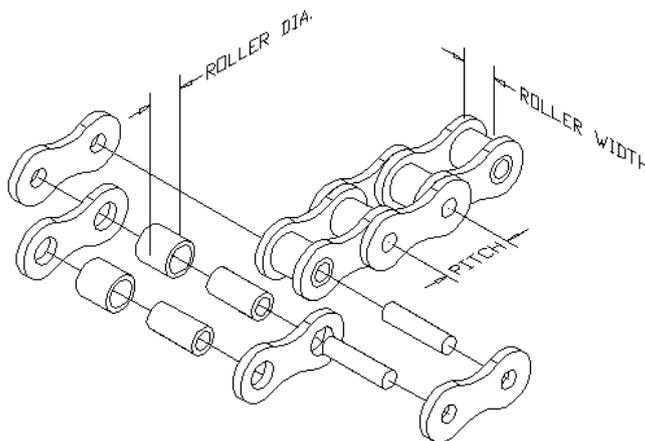
*Roller diameter* – Diâmetro dos rolos; *Roller width* – Largura do rolo; *Pitch* – Passo da corrente
