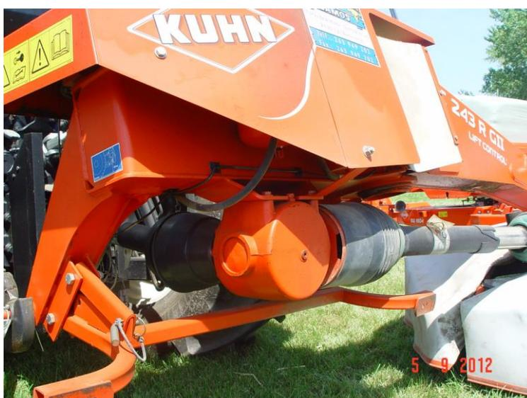
**Carter de engrenagem cônica, com lubrificação**
