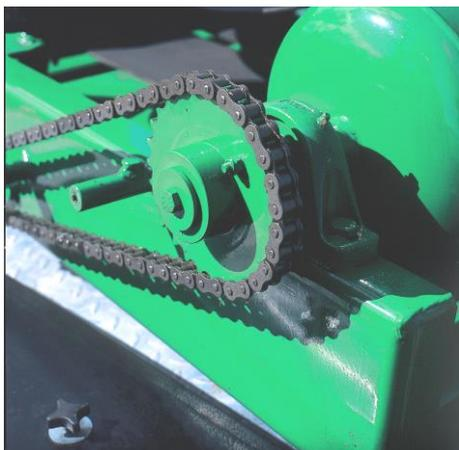
As correntes de rolos (*roller chain*) são montadas em carretos (*sprockets*).
