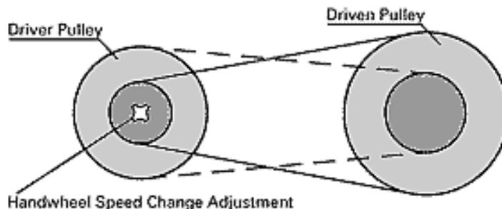
Admita que as polias podem variar entre um raio mínimo ( $r_{\min}$ ) e um raio máximo ( $r_{\max}$ ), igual em ambas.
