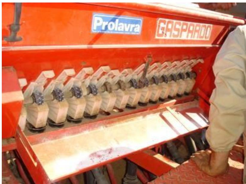
Veio de distribuidores de semente (cilindro dentado) num semeador de fluxo contínuo Gasparado M300
