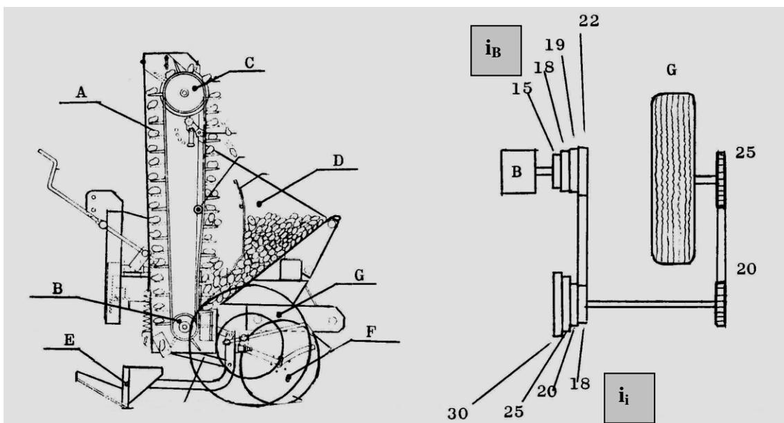
A figura ilustra um plantador de batata, em que o elevador A, montado nos tambores B e C, retira batatas da tremonha D e as deixa cair no rego aberto no terreno pelo abridor E, sendo depois cobertas pelos discos F.
