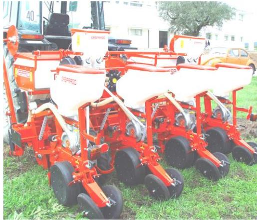
A transmissão começa na roda de movimento (pneu da medida 5.00-15), seguindo-se uma transmissão por corrente de rolos, para um veio de ligação à caixa de velocidades
