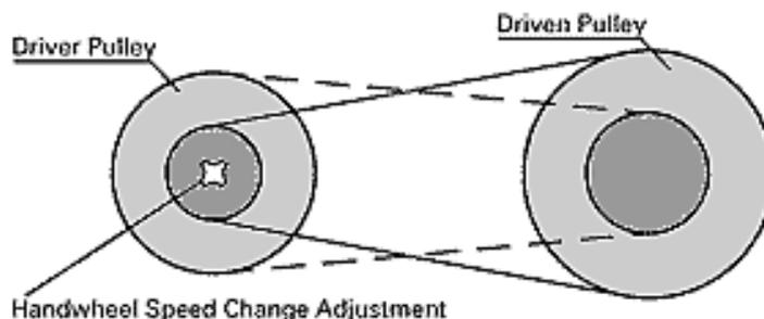
Admitindo uma determinada velocidade da polia motora (*driver pulley*), concluímos que o variador de velocidade permite que a velocidade da polia movida (*driven pulley*) seja diminuída para um valor mínimo (correia representada a traço cheio) ou permite
