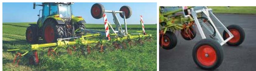
Figura 14 - O virador de feno (*trailed tedder*) da figura, possui um CHDE para actuar as rodas de transporte (*transport wheels*) e um par de CHDE, em paralelo, para o rebatimento dos corpos laterais (*folding wings*). [www.claas.com](http://www.claas.com)
