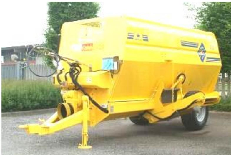
**Figura 32 – Semi-reboque misturador e distribuidor de ração (*mix feeders*) são exemplos frequentes de equipamentos com sistema hidráulico autónomo [www.sgariboldi.it](http://www.sgariboldi.it)**
