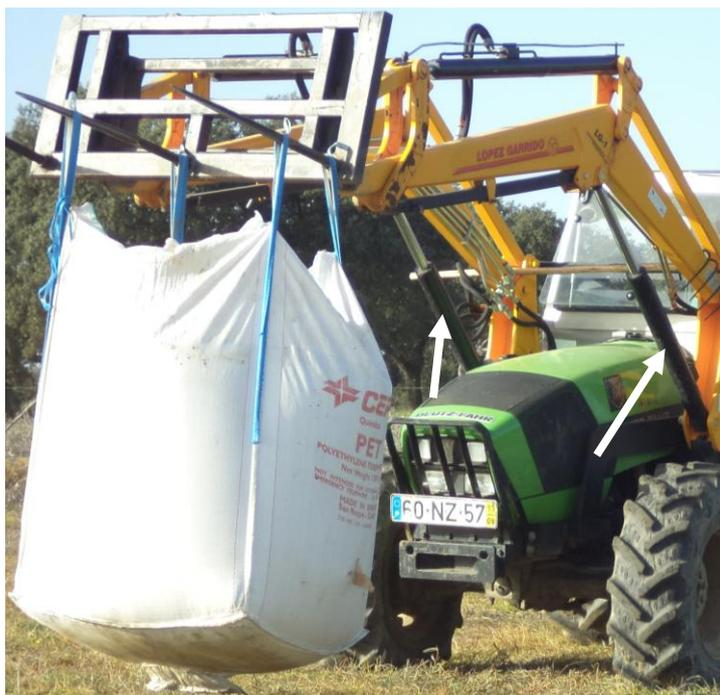
Figura 19 - Um par de CHDE actuados em paralelo rebate a lança do carregador frontal. Para o mesmo caudal, os CHDE encolhem mais depressa do que estende; para uma mesma pressão, os CHDE exercem maior força a estender do que encolher. Como consequência o carregador tem mais força para levantar carga e desce mais depressa para o solo. Tractores e Equipamentos Automotrizes 2014.
