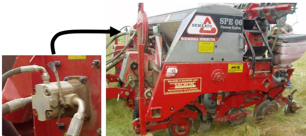
Figura 22 - Motor hidráulico de accionamento do ventilador de um semeador mono-grão, pneumático, de sementeira directa. Controlo de Equipamentos e Mecanização Aplicada -visita de estudo à herdade da Lobeira (Ciborro)
