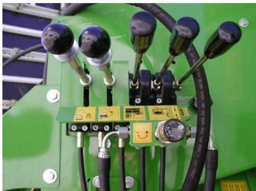
**Figura 34 – Comandos do bloco de válvulas direccionais e de controlo de caudal que permitem dirigir e regular o fluxo de óleo para cilindros e motores hidráulicos dos diferentes órgãos do semi-reboque misturador e distribuidor de ração com sistema hidráulico autónomo**
