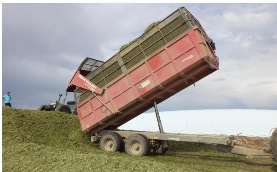
Figura 16 - O semi-reboque (*farm trailer*) da figura dispõe de um CHSE para rebater (*tip*) a caixa; O peso da caixa fará recolher a haste do cilindro.
