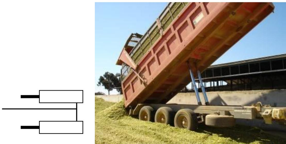
Figura 18 - Semi-reboque basculante com caixa rebatida por dois cilindros hidráulicos de simples efeito (CHSE), em paralelo. Tractores e Equipamentos Automotrizes 2011/12 – Visita à herdade dos Padres
