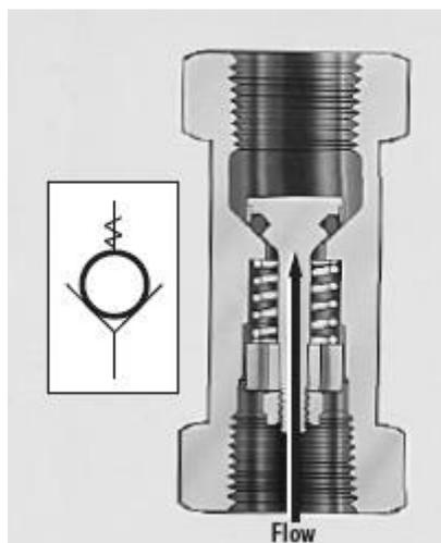
Figura 25 - Válvula de retenção <http://www.hydraulicspneumatics.com/>
