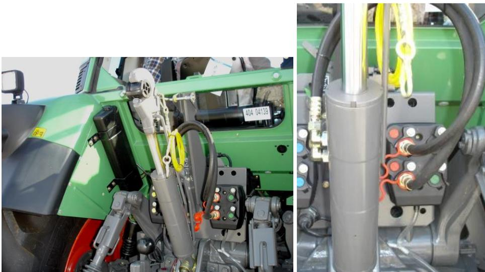
Figura 10 - Cilindro hidráulico de duplo efeito usado como 3º ponto no sistema de 3 pontos do tractor Fendt 415 Vario. Aula de Tractores e Equipamentos Automotrizes 2011/12
