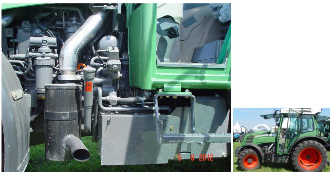
Figura 3 - Reservatório de óleo do sistema hidráulico de um tractor FENDT 211F. Notar o símbolo de óleo de hidráulico colocado no bujão de enchimento.
