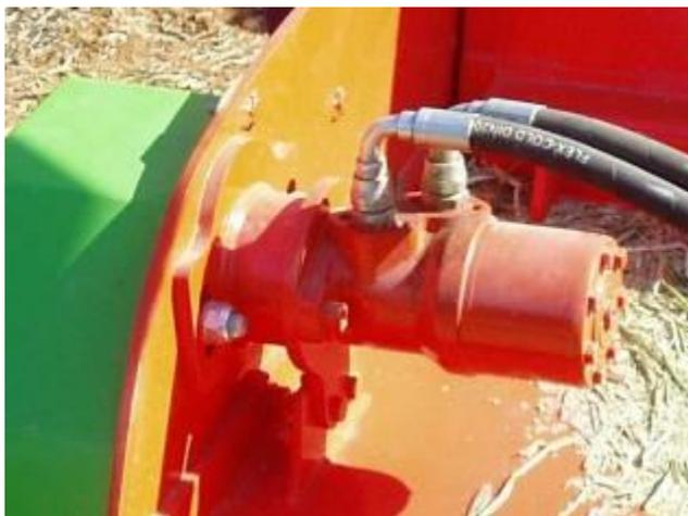
Figura 21 - Motor hidráulico de accionamento de órgãos activos de uma trituradora de rama de poda
