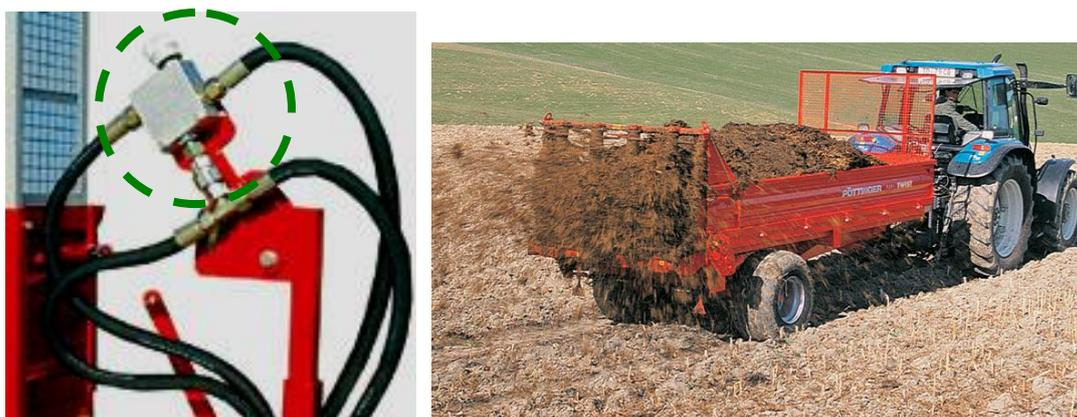
Figura 29 - Válvula de regulação de caudal inserida no circuito de um motor hidráulico (não visível), a qual permite variar a velocidade de translação do fundo móvel de um semi-reboque distribuidor de estrume, possibilitando, assim, regular a densidade de distribuição do estrume (ton/ha).
