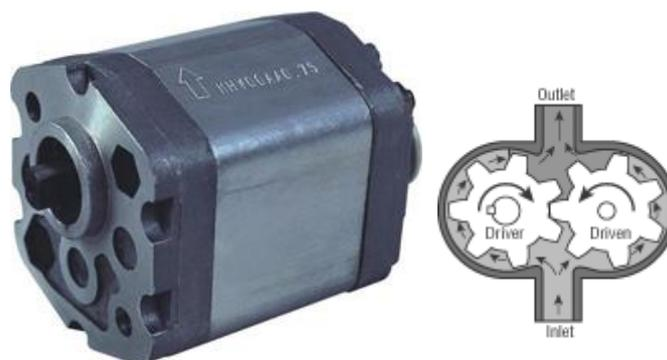
Figura 5 - Bomba de óleo de carretos (aspecto exterior e interior)
