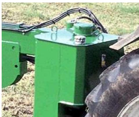
Figura 2 - Reservatório de óleo do sistema hidráulico autónomo de uma máquina de revestir fardos de feno-silagem em película plástica <http://www.mchale.net/>
