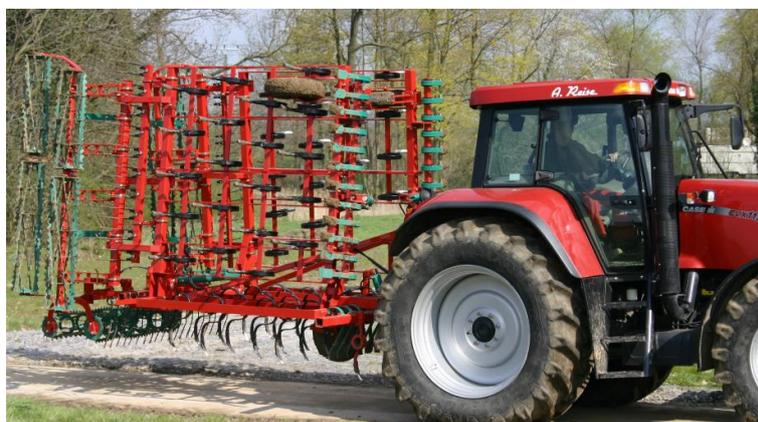
Figura 13 - Os dois cilindros hidráulicos assinalados, actuados em paralelo, rebatem o corpo do lado esquerdo do vibrocultor. Um segundo par de CHDE actuados em paralelo rebate o corpo direito <http://kvernelandgroup.papirfly.no>
