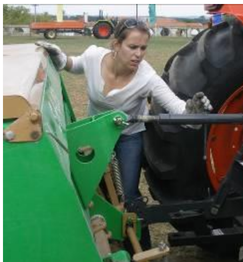
Acerto da inclinação da alfaia no 3º ponto (RURALTEC 2006 - Mitra)
