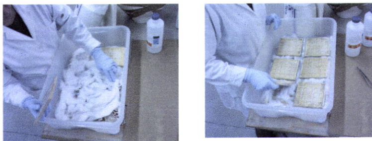
Figura 42 – Disposição dos azulejos embebidos em pachos de peróxido de hidrogénio
