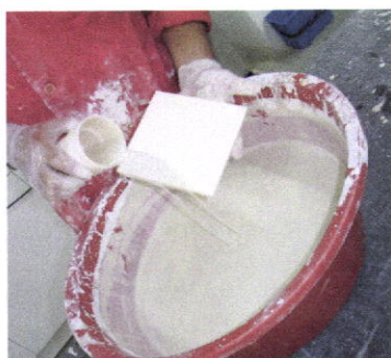
Figura 57 – Processo de vidragem do azulejo
