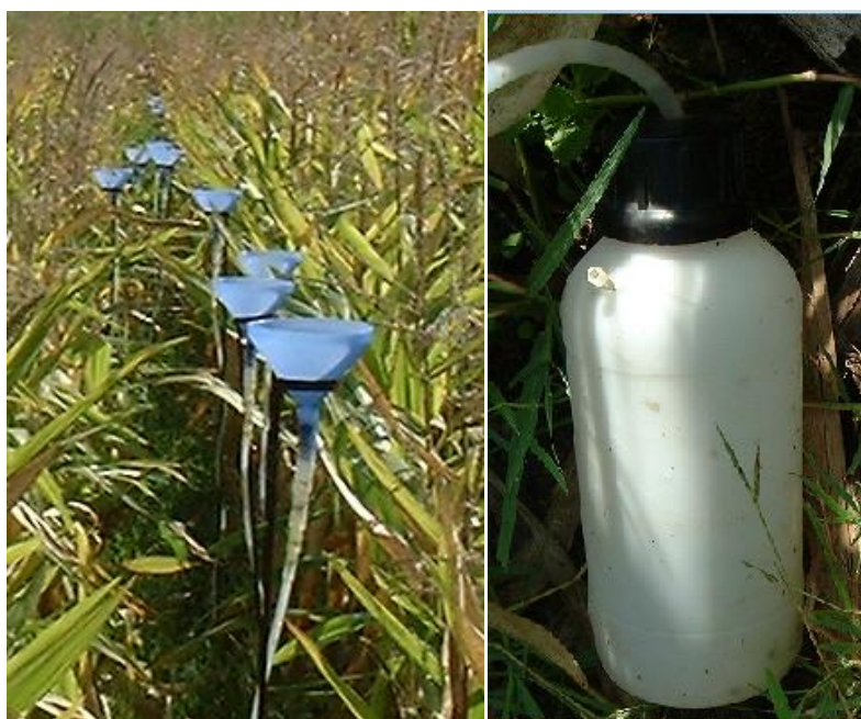
Figura 21 - Pluviómetros alinhados, na foto da esquerda, e à direita o respetivo recipiente coletor com uma agulha de seringa inserida na parte superior, de modo a garantir a pressão atmosférica no interior e, em simultâneo prevenir eventuais perdas por evaporação.
