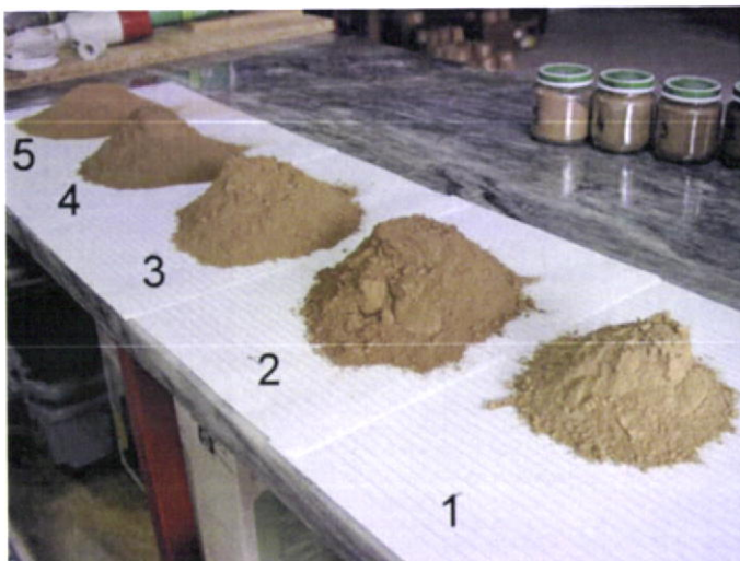
Fig.135-Vista do material passado no peneiro n.º40, onde se observa uma diferenciação de cor entre as várias amostras. Preparação das amostras para a análise granulométrica e determinação dos limites de consistência.
