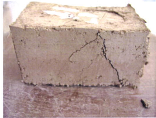
Fig.145-Vista do estado do provete n.º17, armado com duas grelhas de fibra de vidro, após rotura.
