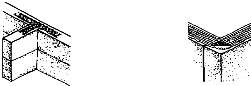
Fig. 240-Exemplo de reforço da taipa, em zonas frágeis como na ligação entre paredes e cunhais.
