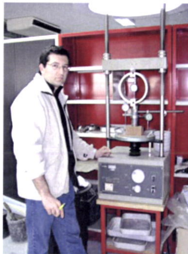
Fig.142-Ensaio dos provetes 12.5x7.5x7cm.
