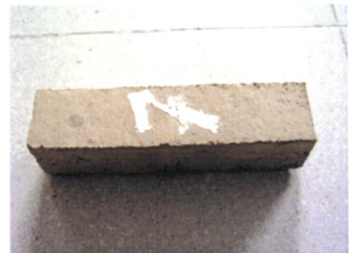
Fig.147-Vista do estado do provete n.º17, armado com duas grelhas de fibra de vidro, após rotura.
