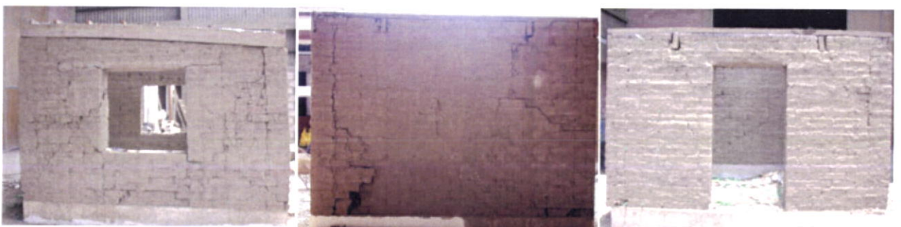
Fig.208-Vista dos danos resultantes da simulação sísmica nas paredes Norte, Oeste e Este, do Modelo2 TORREALVA, Daniel - Agreement number 0600031872 "Shake tables test services for Getty seismic adobe project and project Terra-Final report , Perú : Pontificia Universidad Católica del Perú, 2005. 31p.
