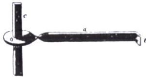
Fig.149-Pormenor de um tipo de Ferrolho idêntico; a-chapa; o-olhal;c-chaveta.
