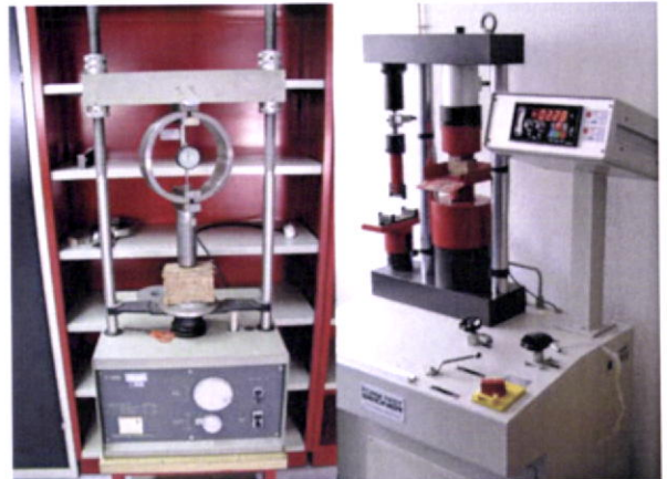
Fig.130-Equipamentos utilizados, maquina de CBR Triaxial-tester T4010 Electronic e maquina de ensaio de argamassas Form+Test Seidner, tipo 505/200/10DM.
