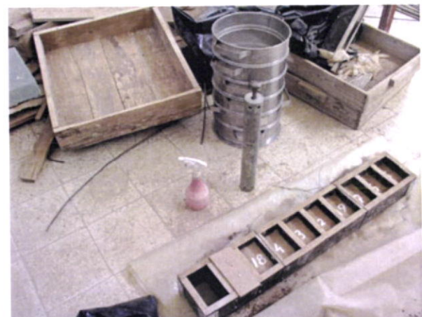
Fig.131-Pormenor do molde e pilão utilizado na execução dos provetes de 12x7x6.5cm.
