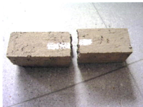
Fig.146-Provetes de solo natural, após rotura
