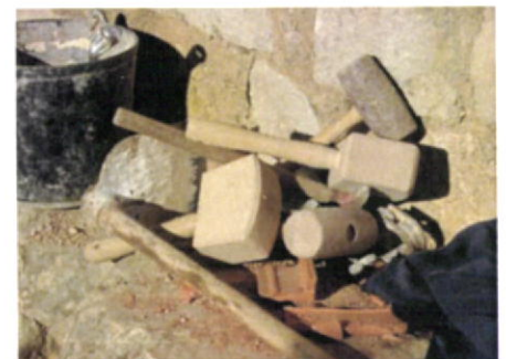
Fig.250-Exemplo dos maços utilizados. Castelo de Paderne 21/12/2004.
