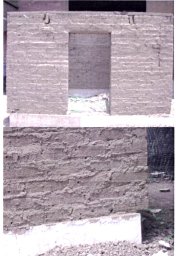
Fig.188-Deslizamento da base da parede norte da maquete do modelo 2 do trabalho de investigação do Getty Conservation Institute e da Universidade Católica do Peru.
