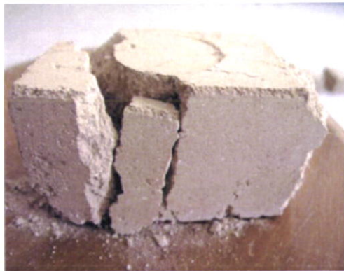
Fig.144-Provetes de solo natural, após rotura.
