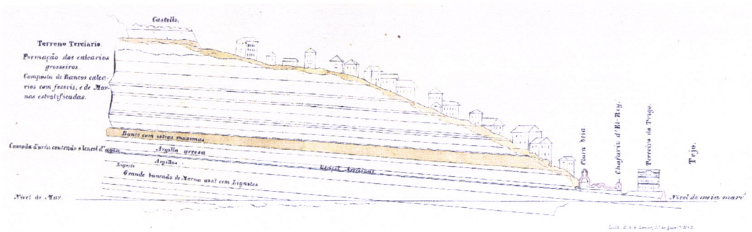
Fig. 1.2 - Corte geológico com indicação dos diferentes estratos, desde o Castelo até ao rio pelo Chafariz D'El-Rei (Secção geológica do Monte do Castelo, Carlos Pezerat, cerca 1868, UPA-CML).
