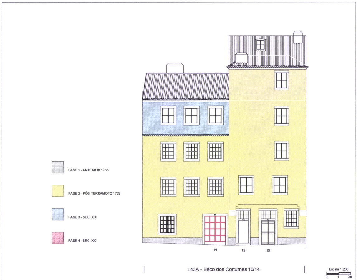
Figs. 4.9 e 4.10 - Evolução construtiva dos 4 edifícios do conjunto L, alçados da Rua de São Pedro e Beco dos Cortumes.
