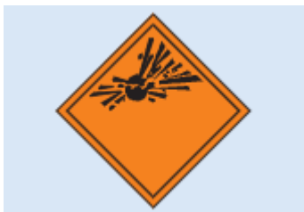
Fig. 3 – Perigo de explosão.
