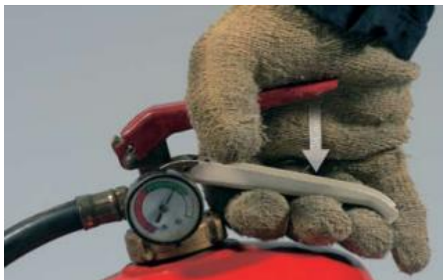
Fig. 33 – Compressão do manípulo de segurança.
