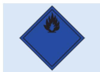
Fig. 8 – Perigo de emissão de gases inflamáveis em contacto com a água.
