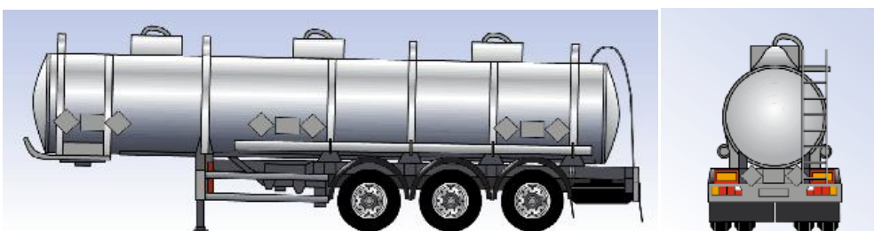
Fig. 21 – Cisterna de transporte de substâncias corrosivas.
