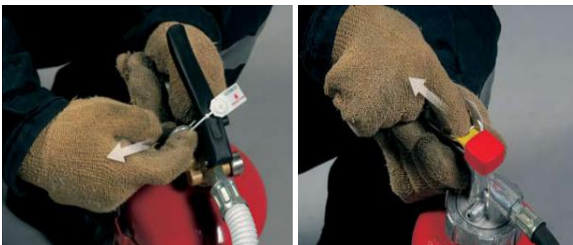
Fig. 32 – Retiro da cavilha de segurança.
